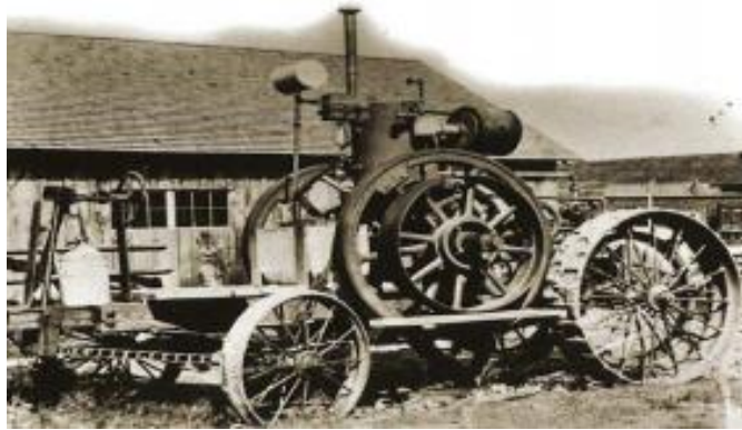
Figura 1 – Trator Froelich movido à gasolina.
