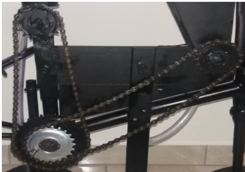
Figura 22 – Localização do módulo de transmissão de potência da plantadeira. Fonte: Dados do autor (2018)
