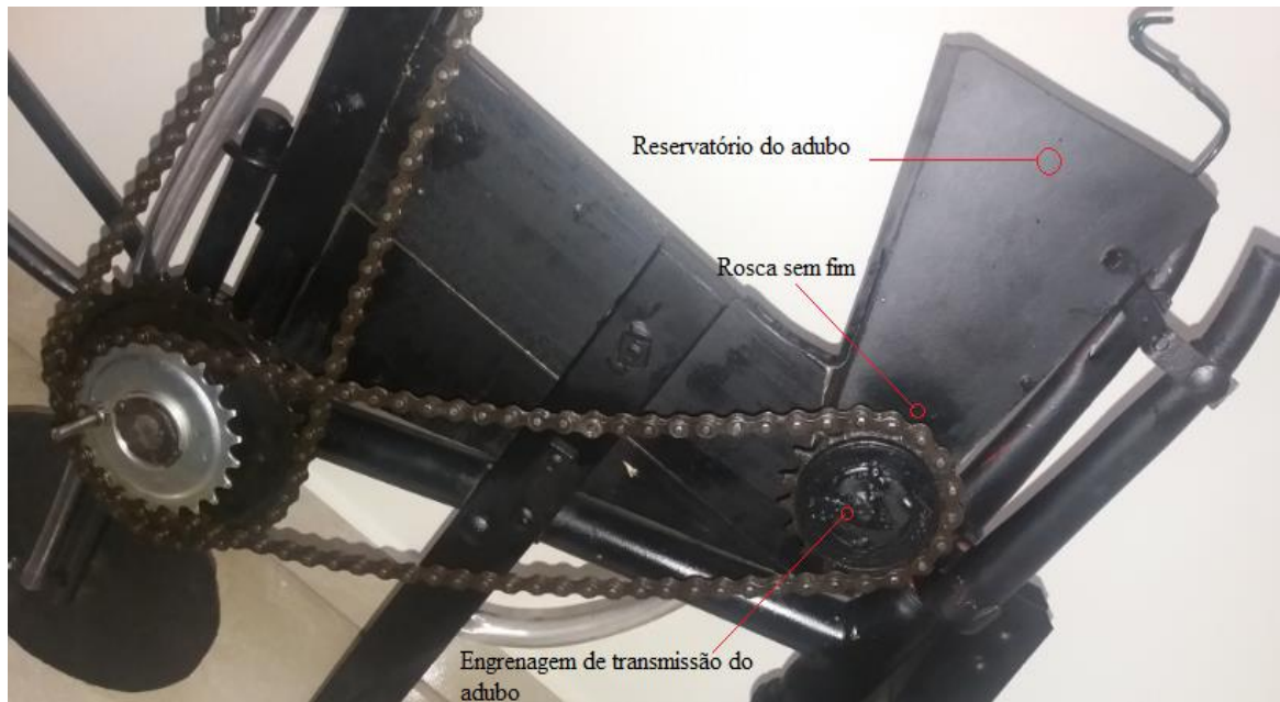
Figura 14 – Localização de conjunto de transmissão do adubo. Fonte: Dados do autor (2018).
