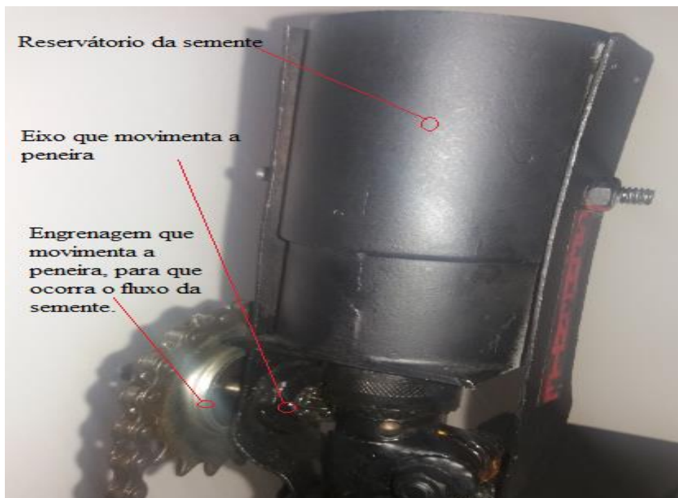
Figura 16 – Localização do módulo de dosagem de semente. Fonte: Dados do autor (2018).
