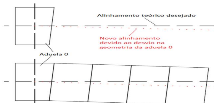
Figura 20 – Alteração do alinhamento devido ao desvio na geometria da aduela de disparo.
