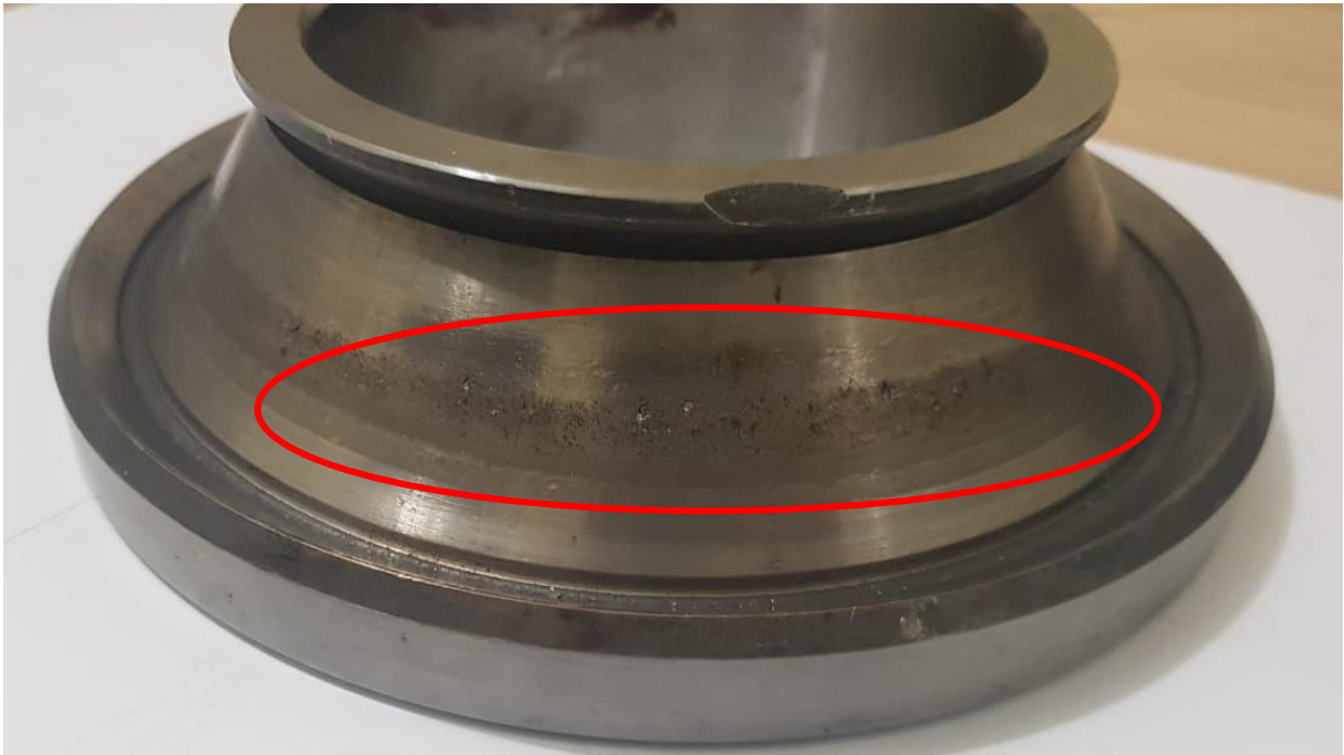
Figura 44 - Ocorrência de pitting na pista interna
