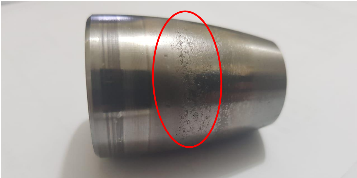
Figura 45 - Ocorrência de pitting nos elementos rolantes
