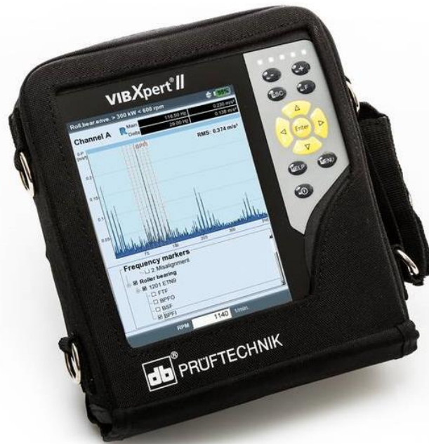
Figura 26 - Analisador de vibração PRUFTECHNIK VIBXPERT II
