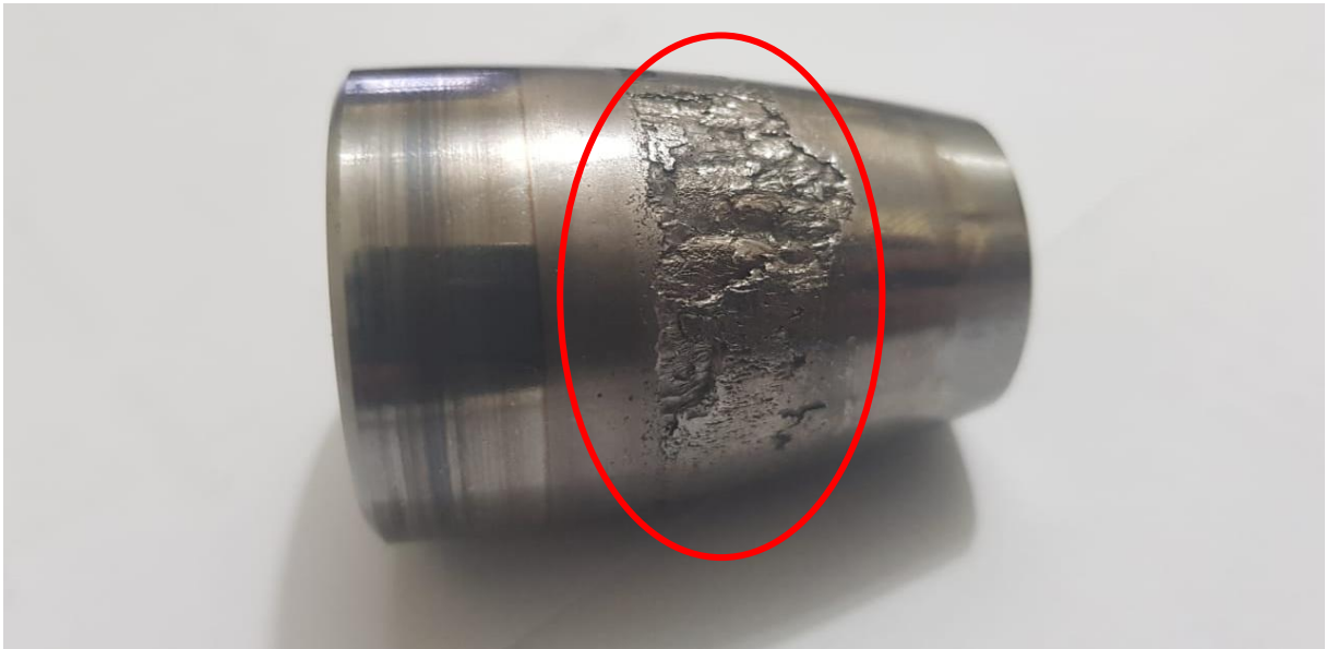
Figura 54 - Ocorrência de escamamento nos elementos rolantes
