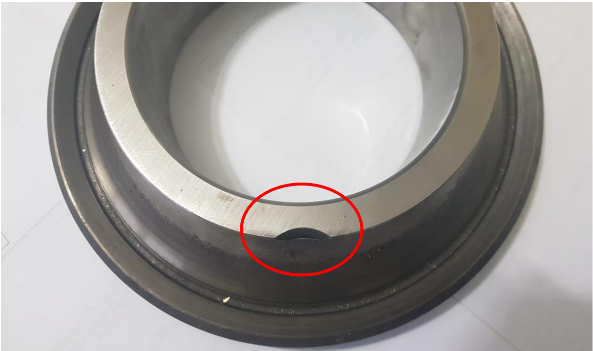
Figura 58 - Ocorrência de fratura no rolamento
