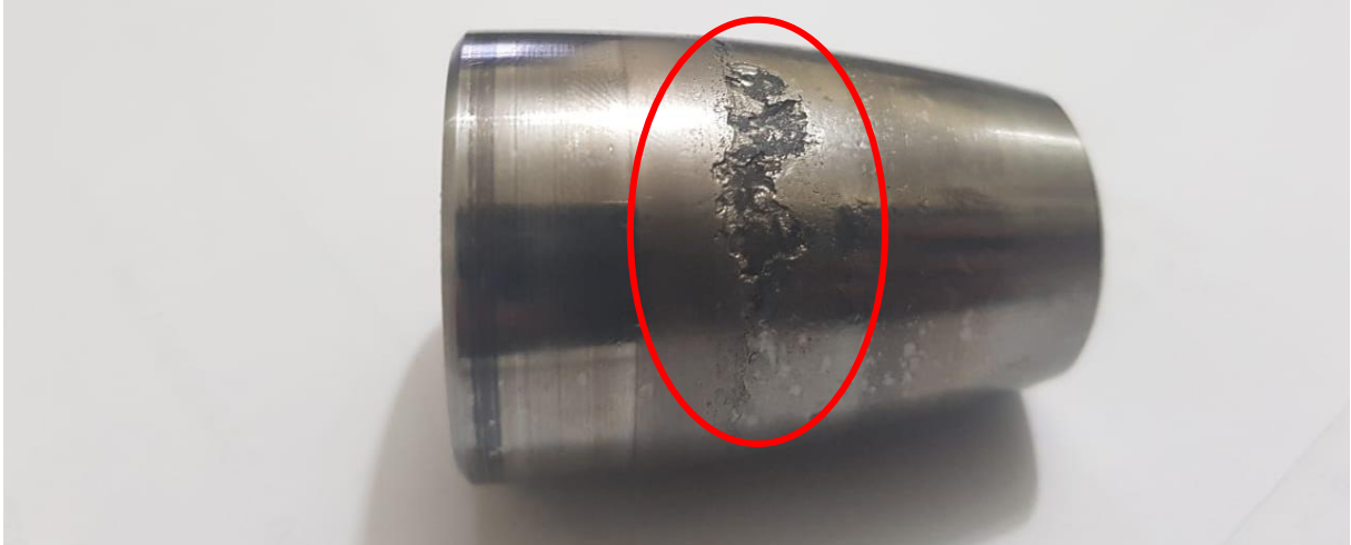
Figura 49 - Ocorrência de descascamento nos elementos rolantes
