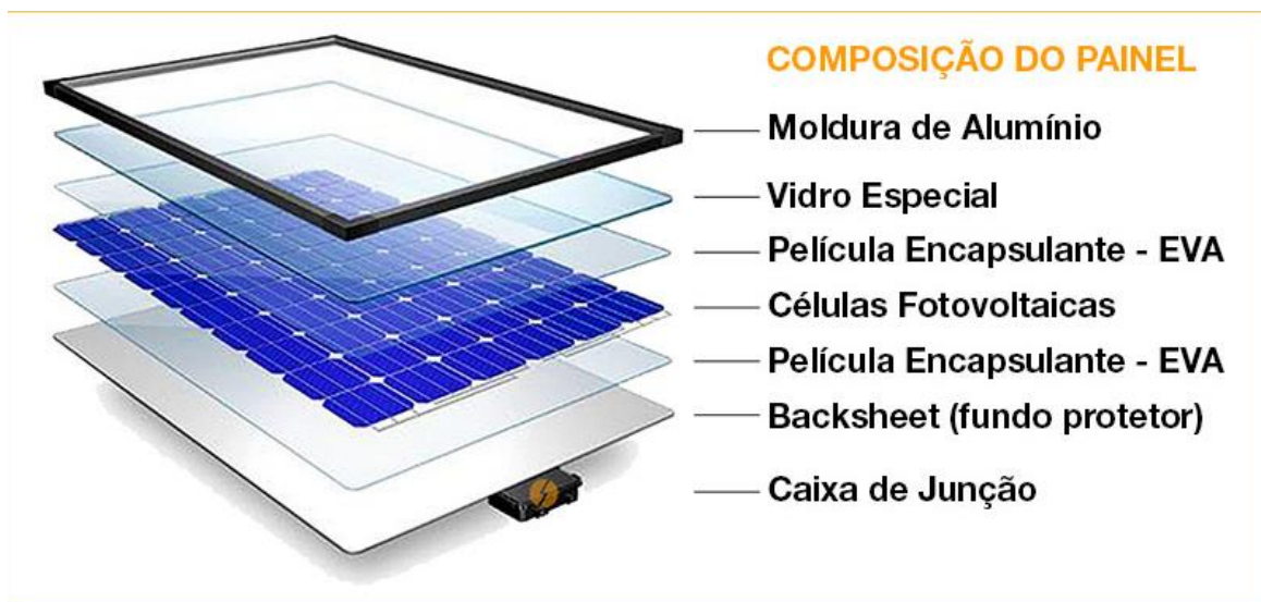
Figura 46 - Composição do Painel Fotovoltaico Fonte: Site – Portal Solar
