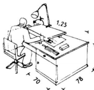
Prancheta com pés rebatíveis sobre a mesa à suficiente altura para que a régua possa passar por cima do material de desenho
