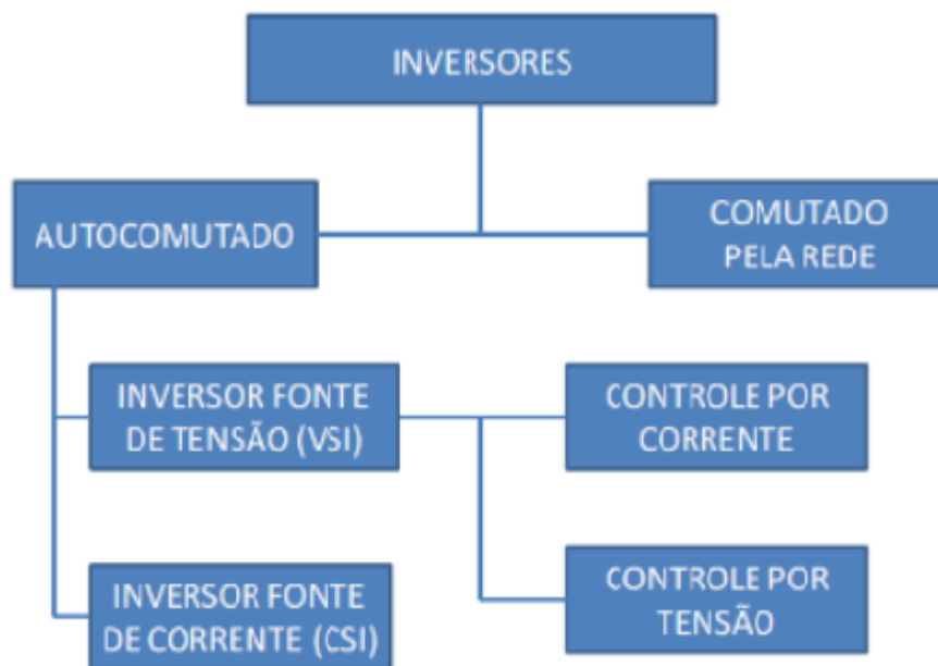
Figura 19: Inversores e métodos de funcionamento.
