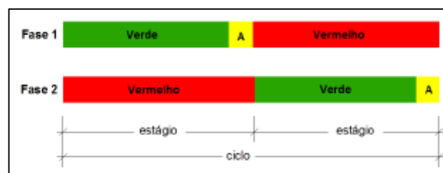
Figura 19. Exemplo de diagrama de estágio. Fonte: (ROESS, ET AL 2004).
