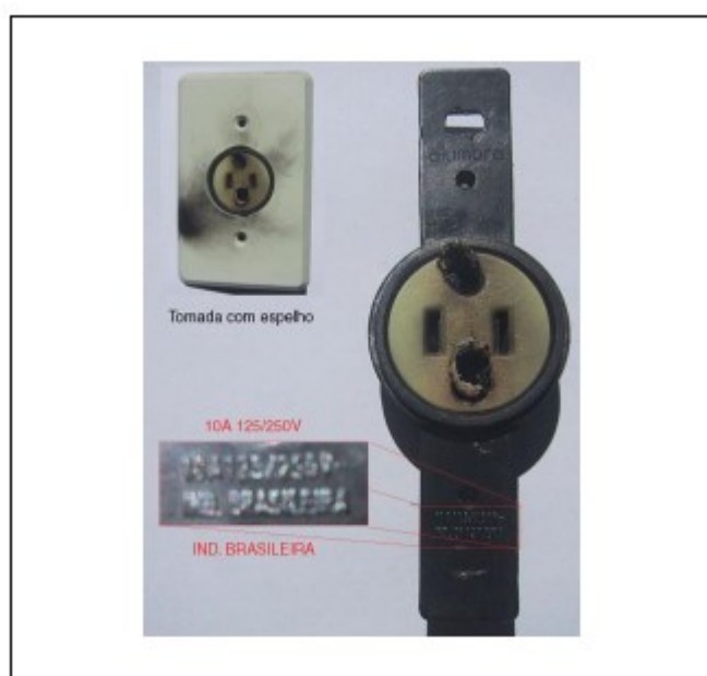
FIGURA 15 – TOMADA DE CORRENTE SUBMETIDA A UMA SOBRECARGA
