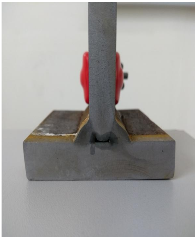
Figura 25: Macrografia processo de soldagem MAG usada.
