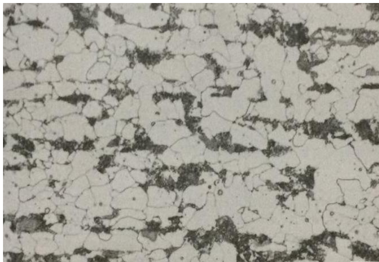
Figura 31: Região onde ocorreu leve esferoidização dos carbonetos de perlita. Ferrita e perlita levemente esferoidizada.
