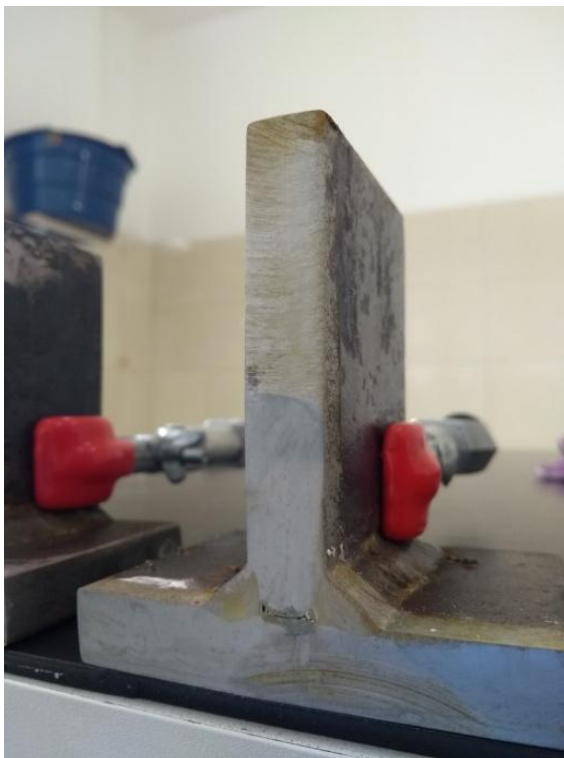
Figura 24: Macrografia processo de soldagem MAG, com solução Nital 10%.
