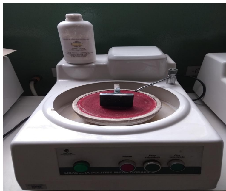
Figura 21: Polimento das superfícies a serem analisadas com alumina.
