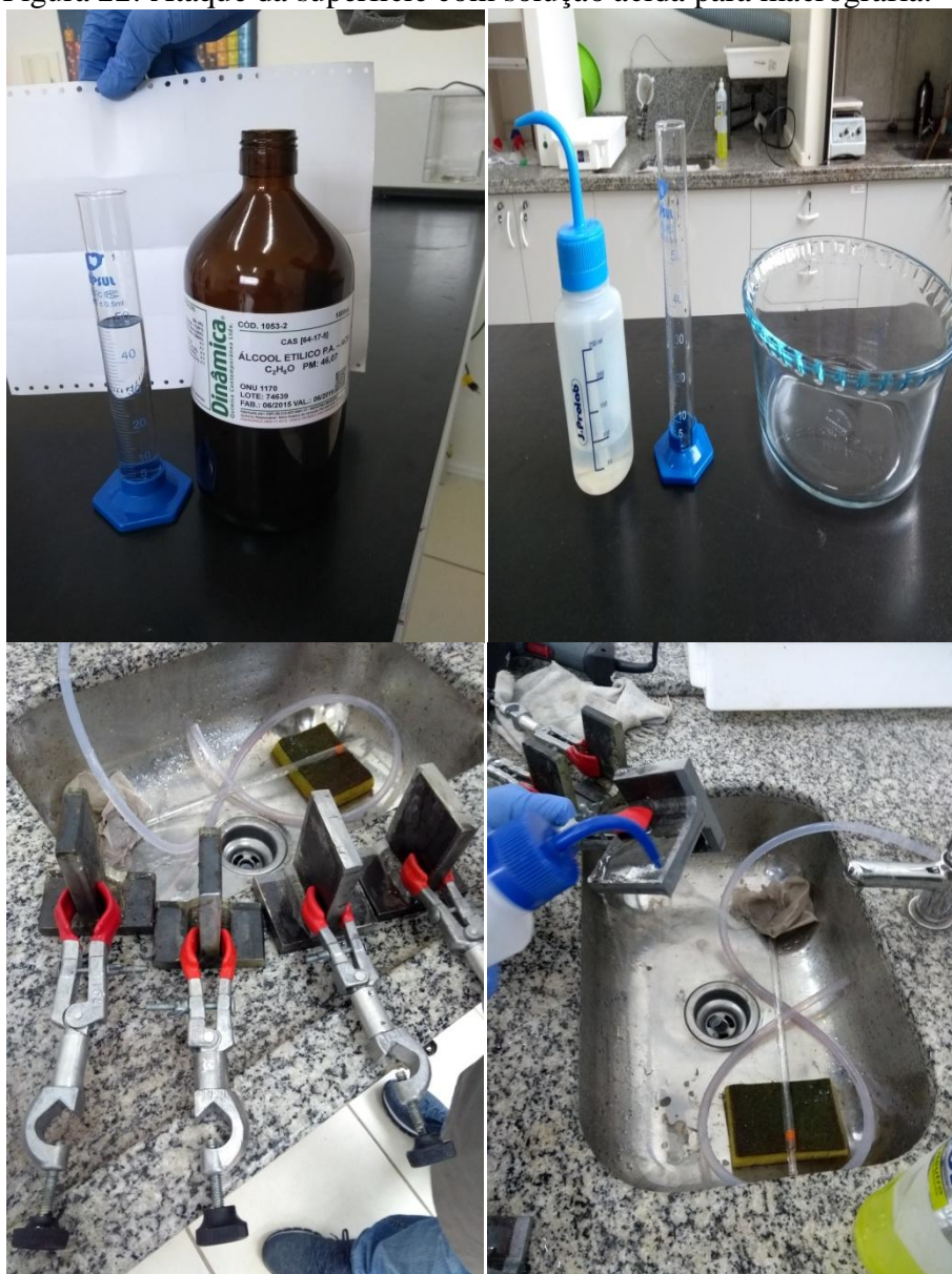
Figura 22: Ataque da superfície com solução acida para macrografia.
