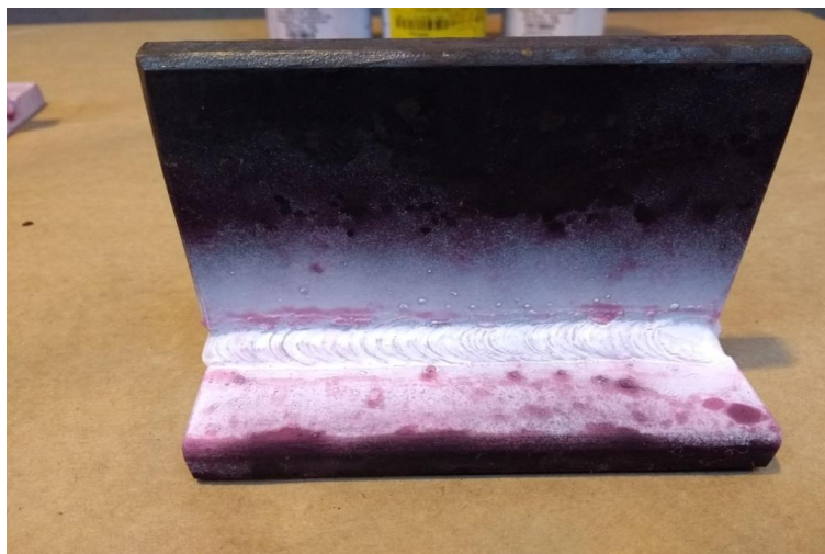
Figura 17: Análise líquido penetrante em solda com eletrodo chapa nova.
