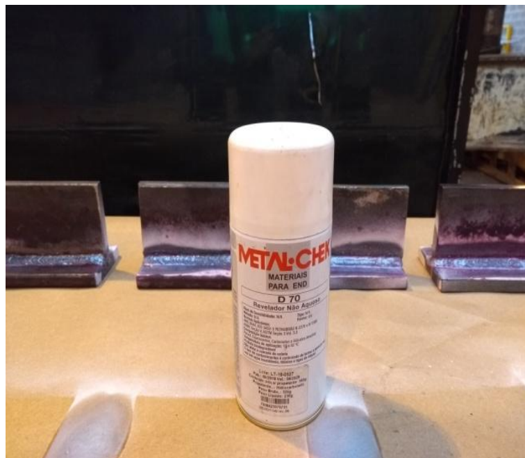
Figura 14: Aplicação do revelador.
