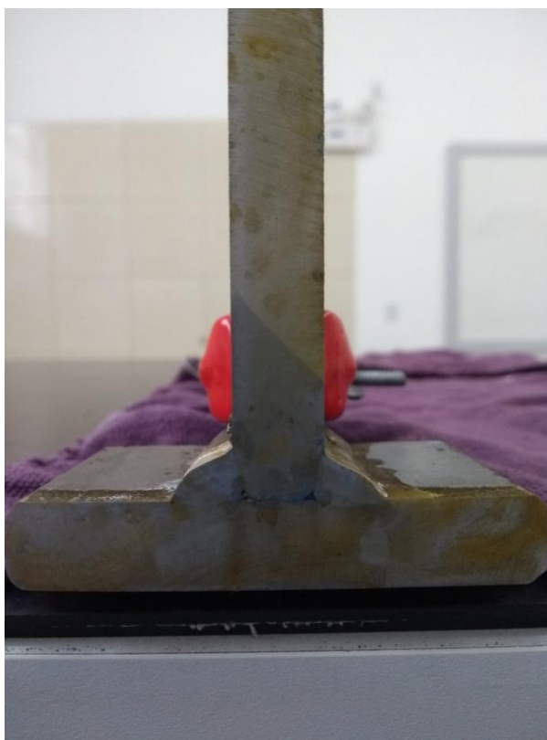
Figura 23: Macrografia ataque com solução de ácido clorídrico, MAG em chapa nova nova.
