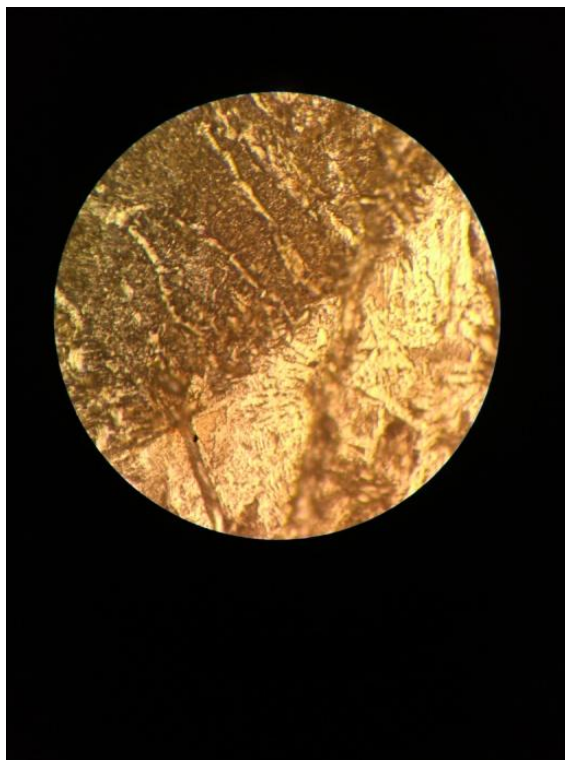
Figura 37: Material de adição X material de base, processo de soldagem eletrodo em chapa usada.
