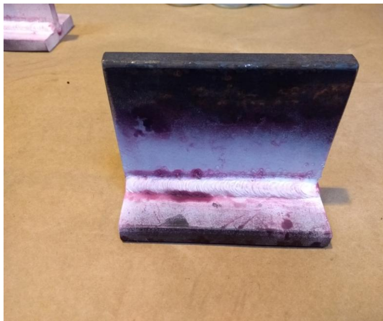
Figura 15: Análise líquido penetrante em solda MAG nova.
