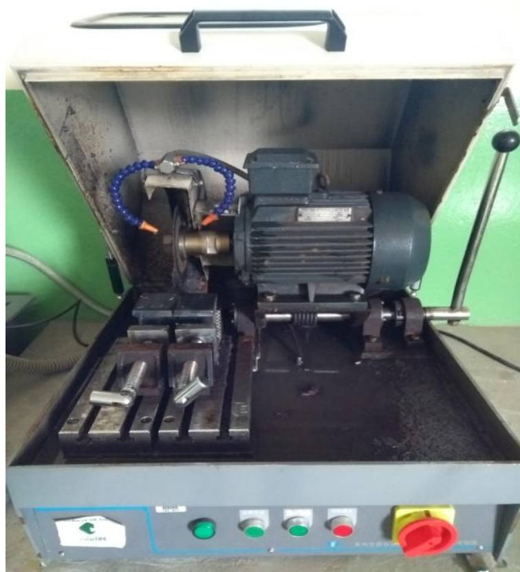
Figura 19: Policorte metalográfico com refrigeração.
