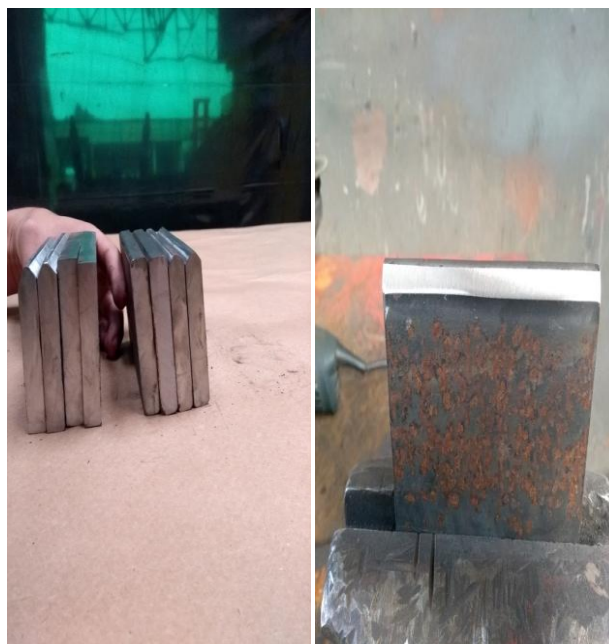
Figura 8: Chanframento e limpeza das pecas a serem soldadas.
