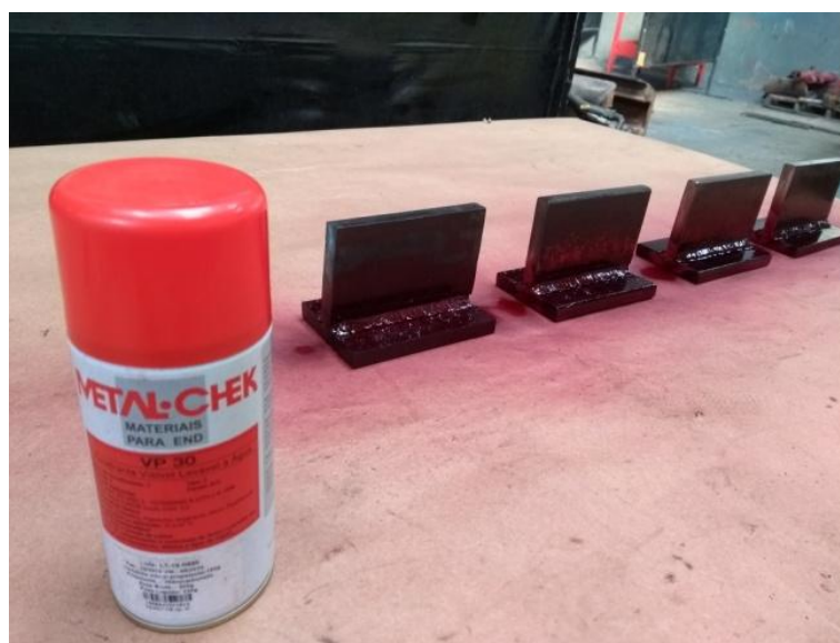
Figura 12: Aplicação do Líquido Penetrante.
