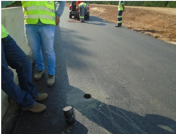
Figura 18 – Corpo de prova, leitura com densímetro
