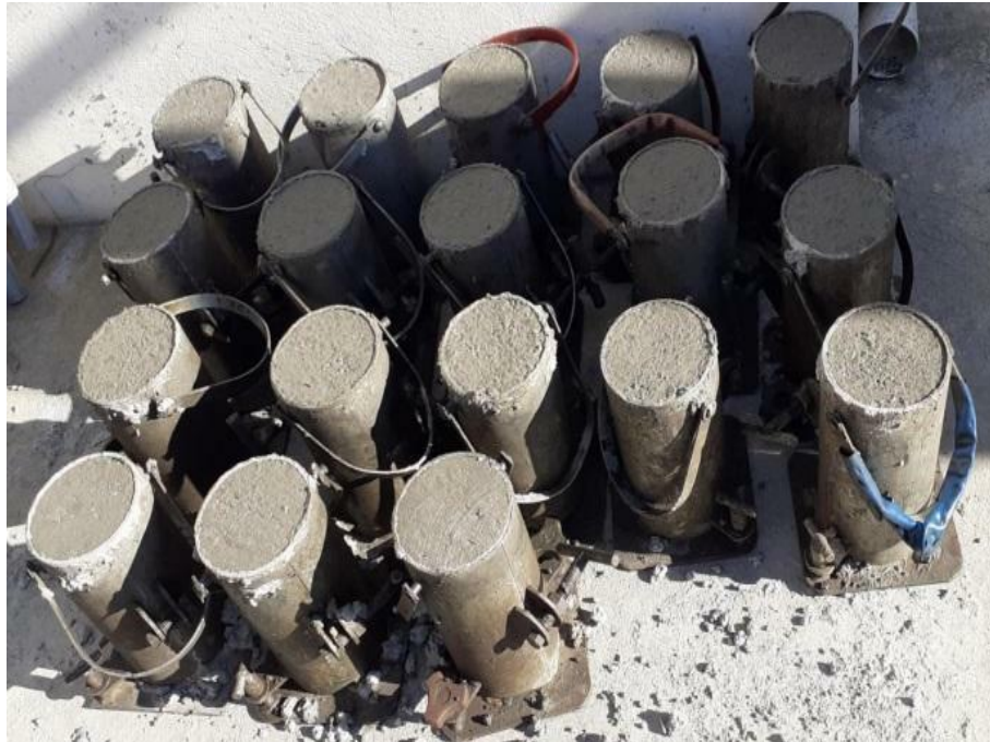
Figura 14: Moldagem de corpo de prova
