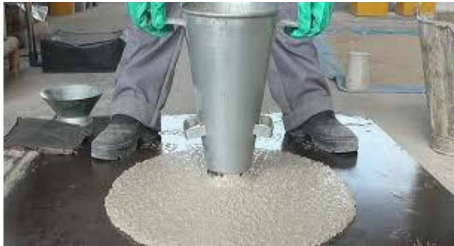
Figura 6: Ensaio de espalhamento do CAA ( Slump Flow )
