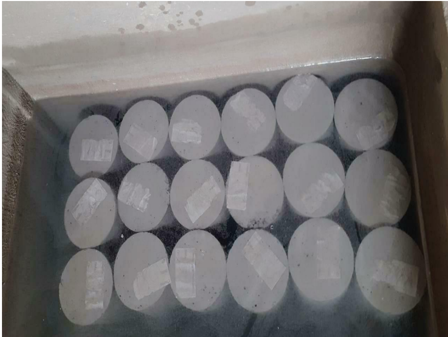
Figura 15: Tanque de cura
