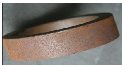
Figura 19 – Corrosão atmosférica no aço carbono
