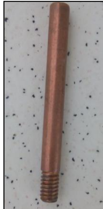
Figura 32 – Bico de cobre para tocha mig/mag exposto em Lages SC
