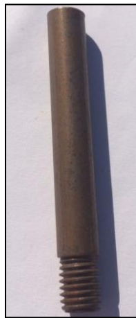
Figura 33 – Bico de cobre para tocha mig/mag exposto em Içara SC
