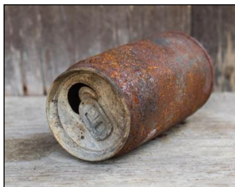
Figura 20 – Corrosão atmosférica no alumínio
