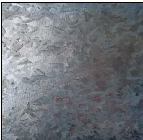
Figura 23 – Chapa de aço galvanizado utilizado como corpo de prova
