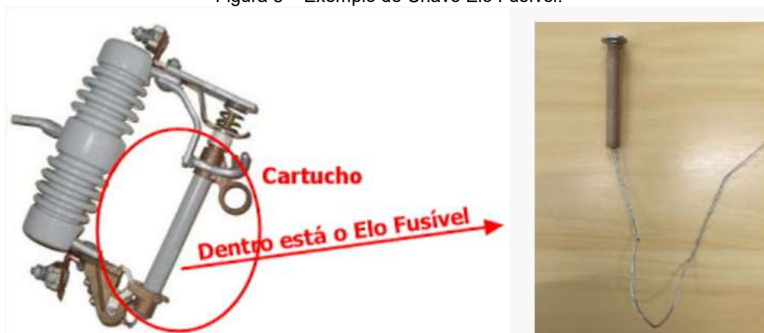
Figura 8 – Exemplo de Chave Elo Fusível.
