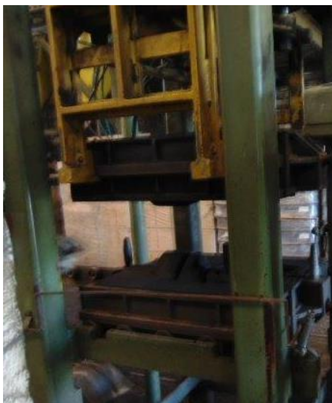
Imagem 9: Máquina de moldagem Vick GC100 fechamento do molde.
