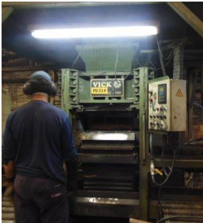
Imagem 6: Máquina de moldagem Vick GC100
