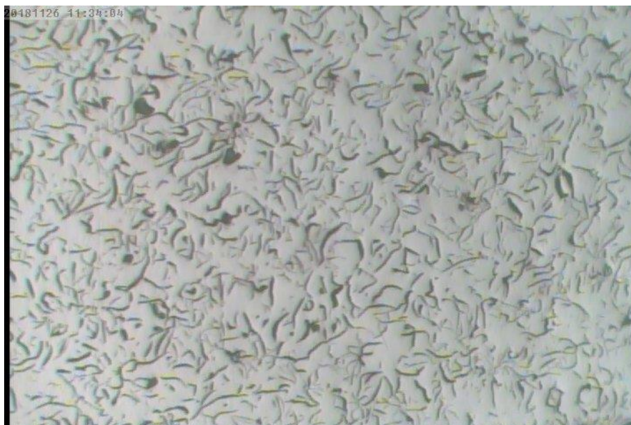
Imagem 18: Metalografia ferro fundido cinzento
