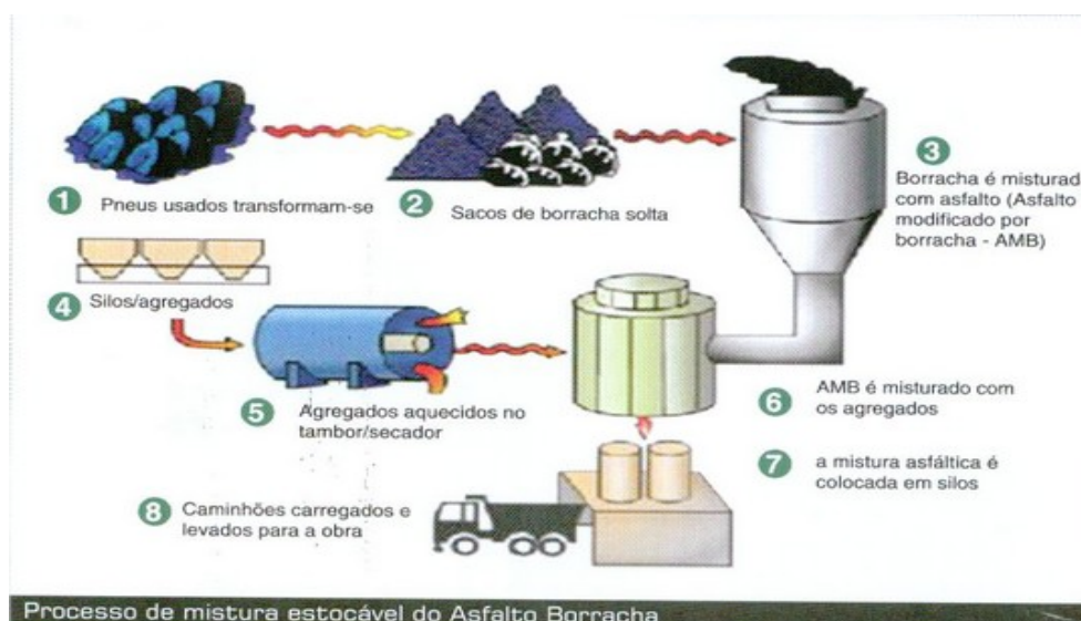
Figura 36- Processo de mistura estocável do Asfalto Borracha. Fonte: Do Pneu à Indústria.
