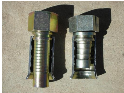
Figura 25 – Erro de montagem mangueira/terminal.
