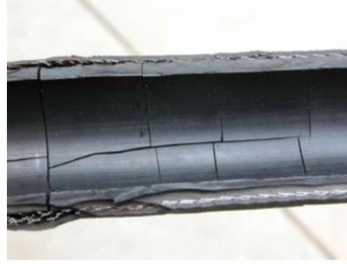
Figura 22 – Mangueira hidráulica deteriorada devido a temperatura.
