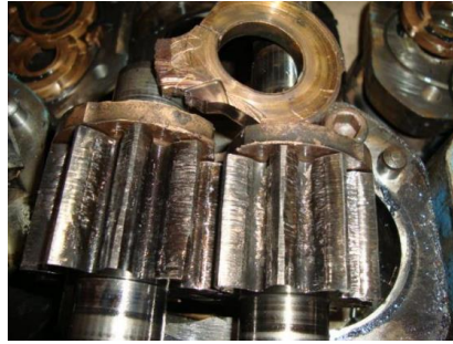
Figura 20 – Bomba de engrenagem desgastada por contaminação.
