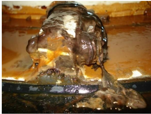
Figura 14 – Efeito da contaminação do fluido hidráulico.
