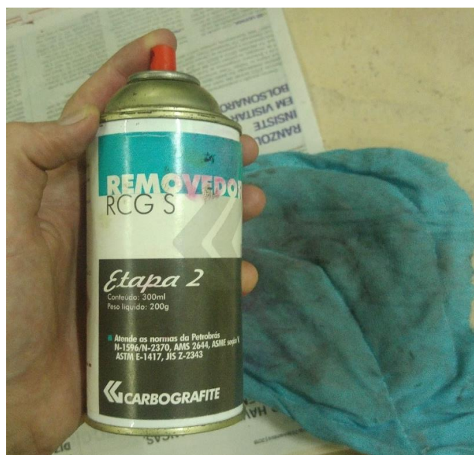
Figura 35 - Remoção do líquido penetrante
