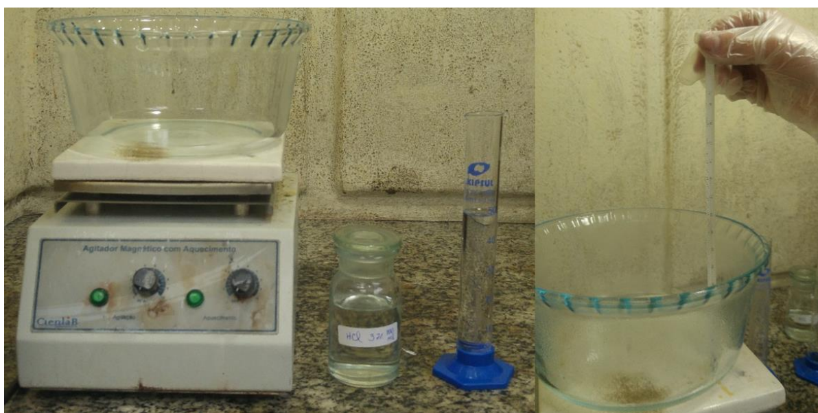
Figura 29 - Preparação da solução para o teste macrográfico
