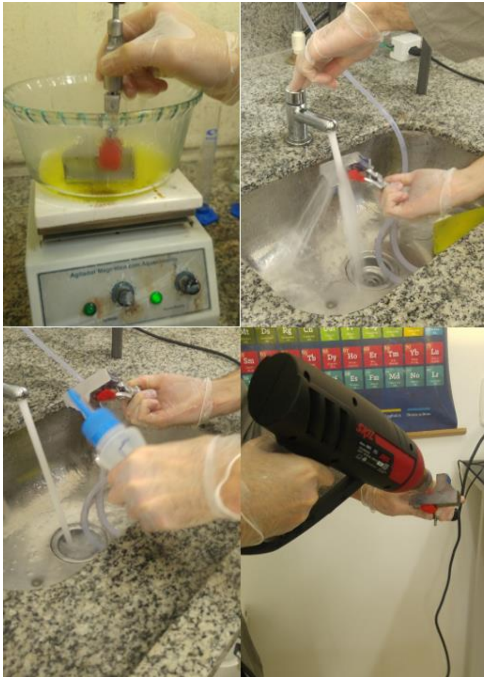
Figura 30 - Ataque de ácido clorídrico na superfície do corpo de prova
