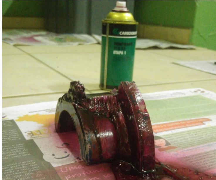
Figura 34 - Aplicação do líquido penetrante
