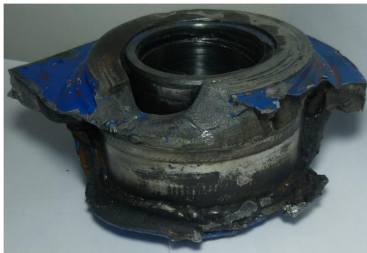
Figura 22 - Detalhe da solda e pontos de ruptura da chapa
