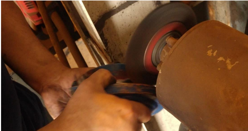
Figura 32 - Remoção da tinta ao longo do longo do cordão de solda
