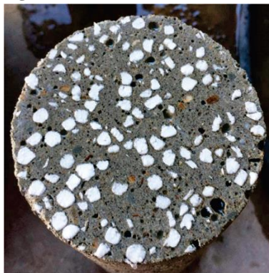
Figura 14 – Concreto com E.P.S. reciclado
