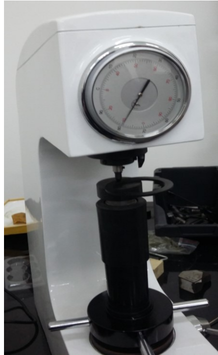
Figura 12: Medição de dureza, material teflon (3)
