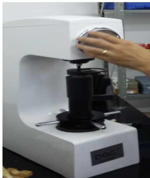
Figura 9: Aferindo o aparelho durômetro
