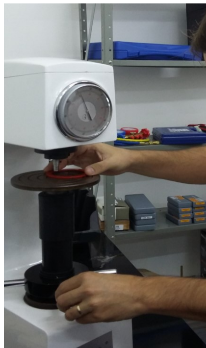
Figura 13: Medição de dureza, material aço (1)
