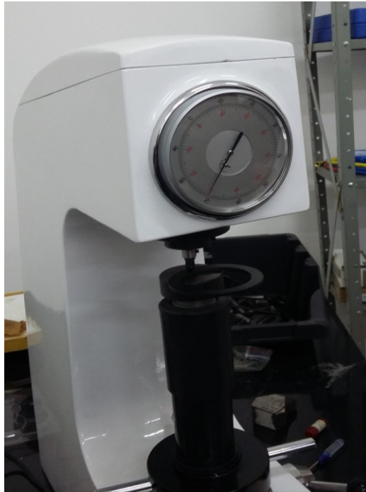
Figura 10: Medição de dureza, material teflon (1)
