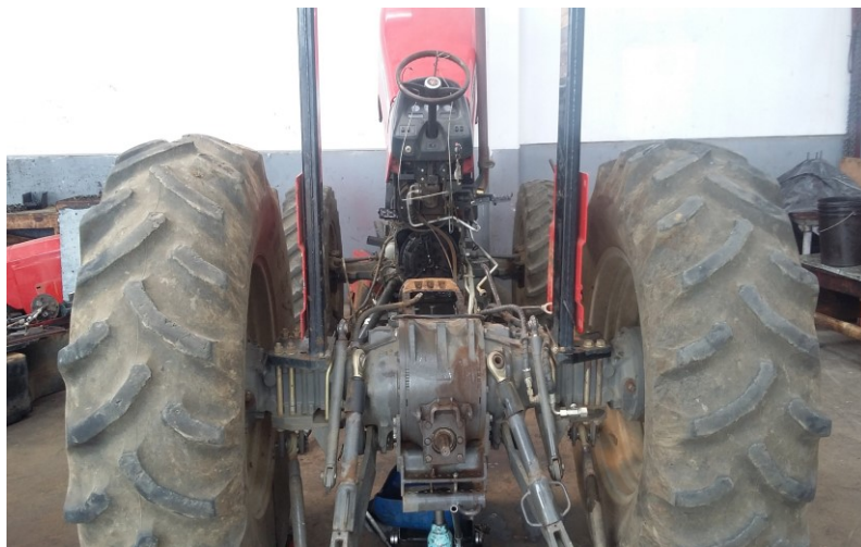
Figura 19: Vista traseira do trator sem o sistema de transmissão
