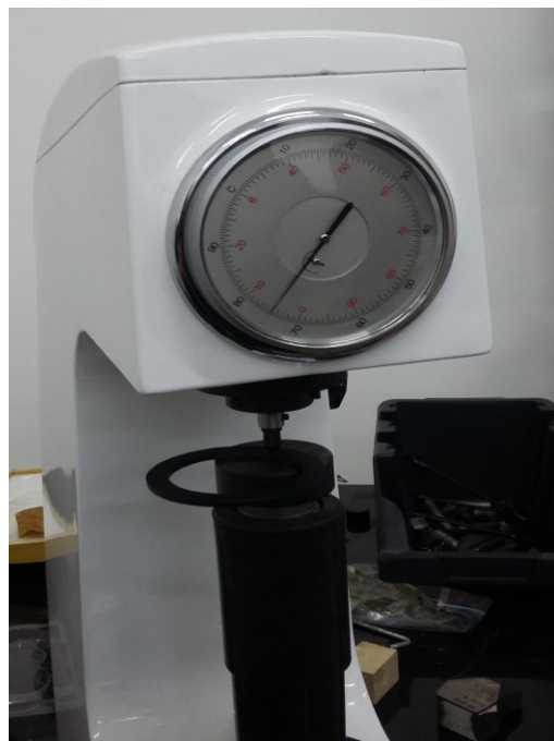
Figura 11: Medição de dureza, material teflon (2)
