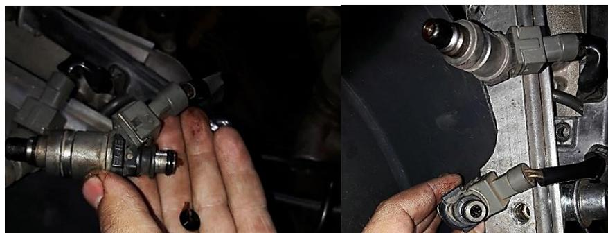
Figura 34 - Bico injetor com a peneira danificada (Fonte: Autor)
