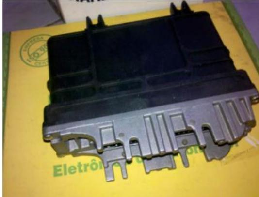
Figura 3 – Unidade de comando eletrônico (ECU) (Fonte: Truosolo, 2013)
