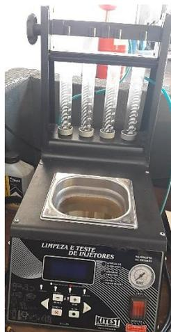
Figura 36 - Equipamento de Limpeza e teste de Injetores (Fonte: Autor)
