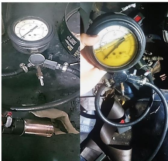
Figura 44 - Teste de Pressão com Manômetro (Fonte: Autor)
