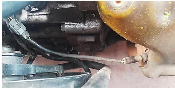
Figura 39 - Sonda Lambda (Fonte: Autor)
