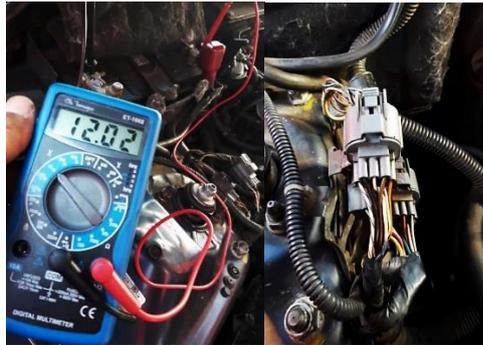
Figura 50 - Teste da bateria e chicote elétrico (Fonte: Autor)
