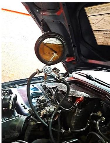
Figura 45 - Novo teste de pressão da bomba (Fonte: Autor)
