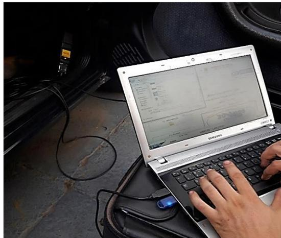
Figura 27- Cabos de diagnóstico conectado (Fonte: Autor)
