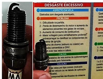
Figura 49 - Velas com Desgaste (Fonte: Autor)
