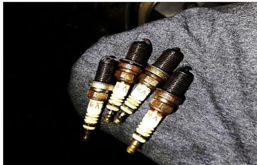
Figura 48 - Velas de Ignição (Fonte: Autor)
