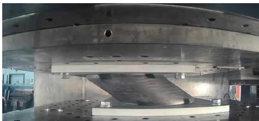
Figura 04 – Teste de abalo em rolamento de borracha
