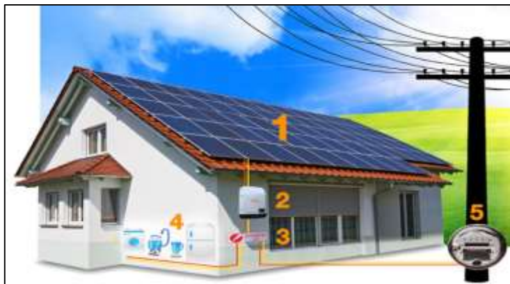
Figura 18 – Sistema fotovoltaico conectado à rede.
