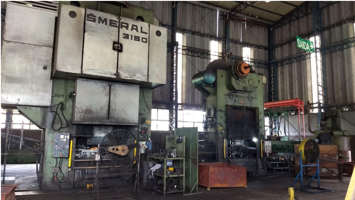
Imagem 4: Processo de forjamento prensa excêntrica
