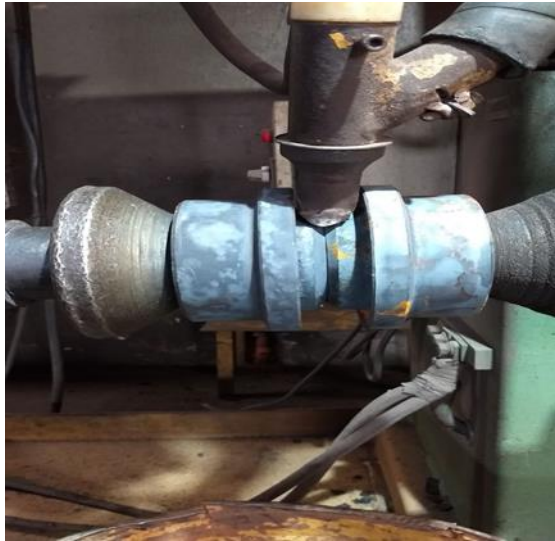
Imagem 5: Processo de soldagem Arco Submerso
