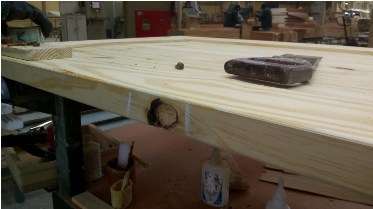
Figura 10: Peça com defeito, falta o nó na madeira.
