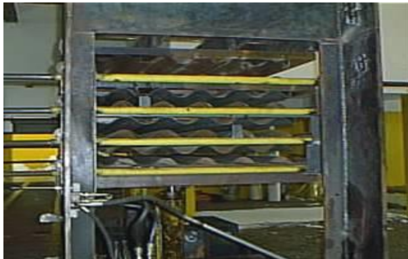
Figura 9 - Prensa a quente de telhas Tetra Pak
