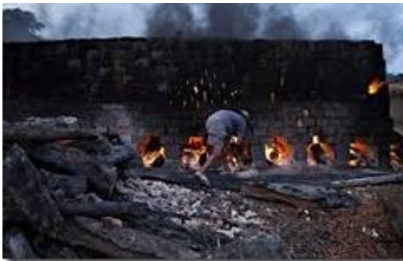
Figura 21 - Forno telha cerâmica
