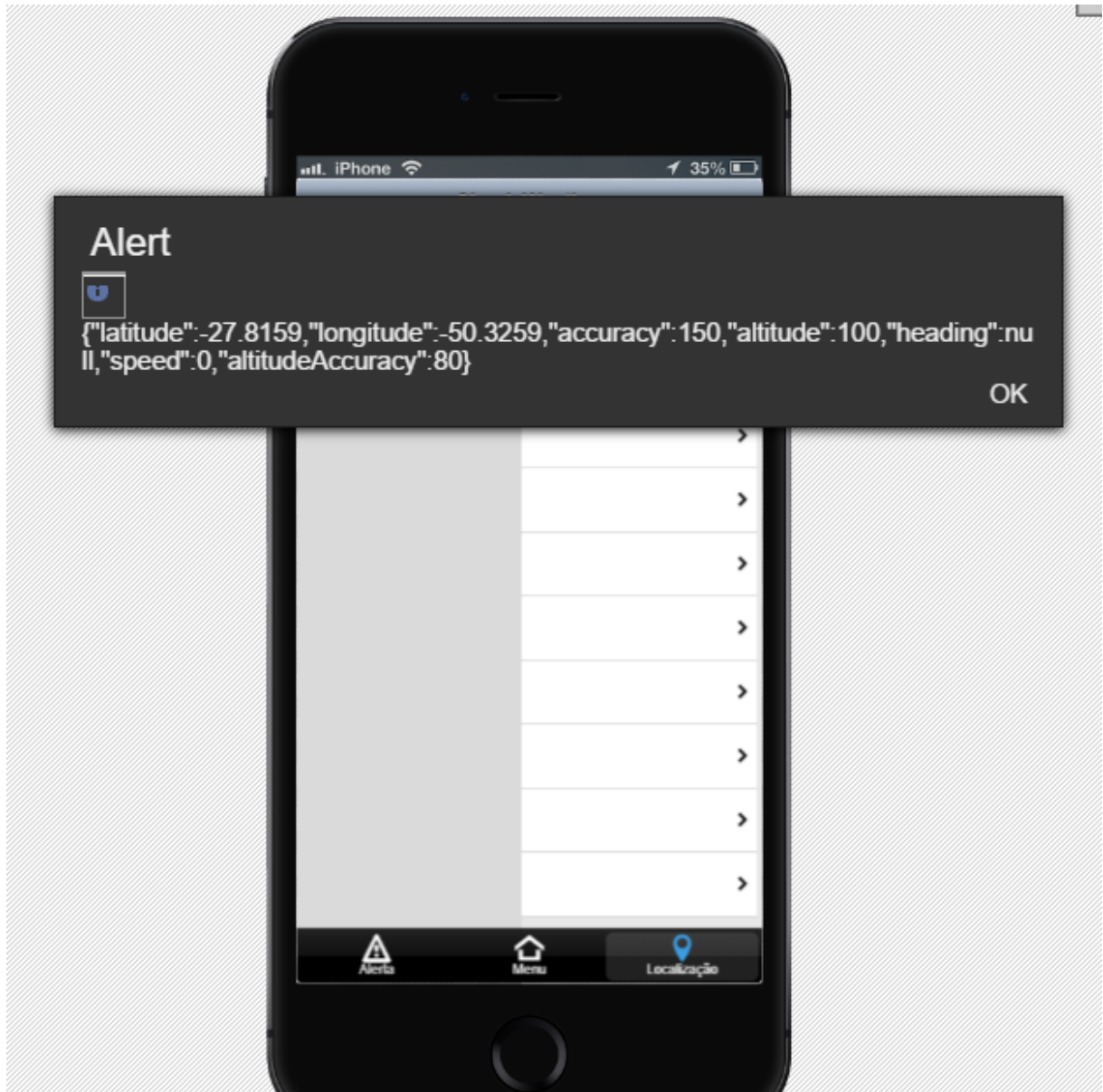
Figura 10: Interface de informação sobre a posição do dispositivo.
