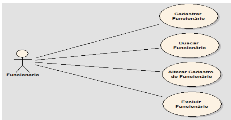
Figura 06 – Diagrama de caso de uso com ações pertinentes à registro de funcionários no sistema.
