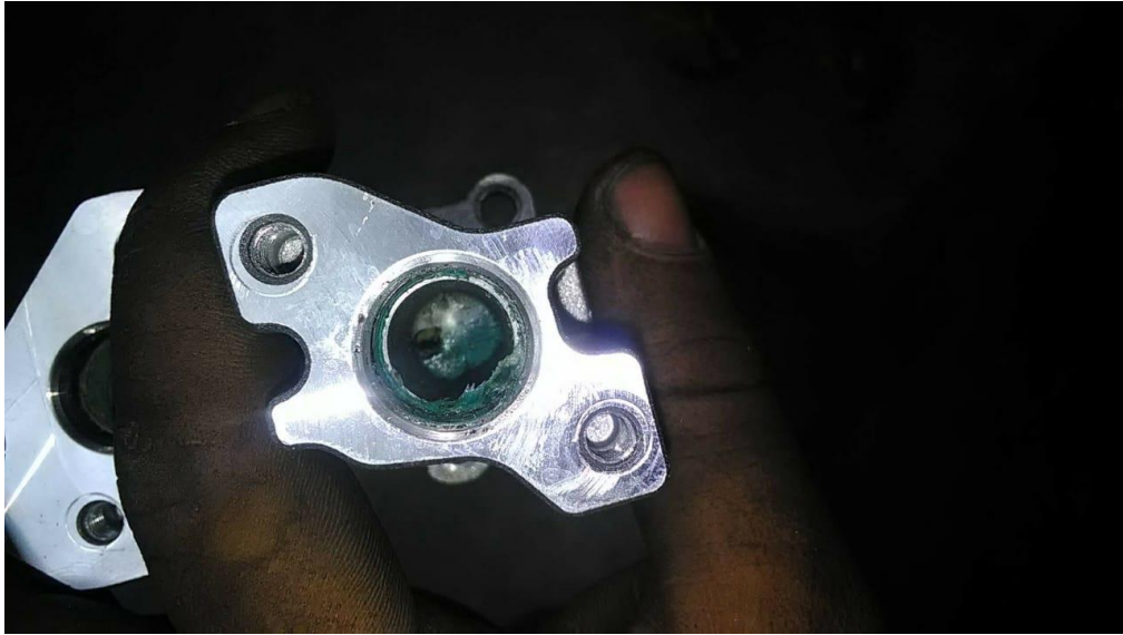
Figura 34: Torre de passagem do fluxo de ar, obstruída
