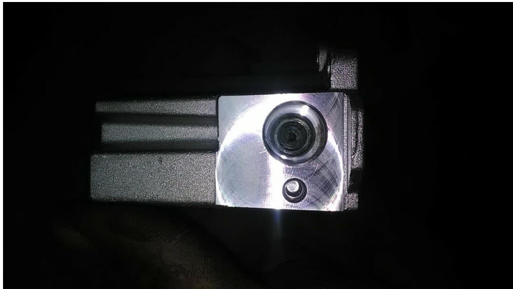
Figura 33: Torre de passagem do fluxo de ar, obstruída
