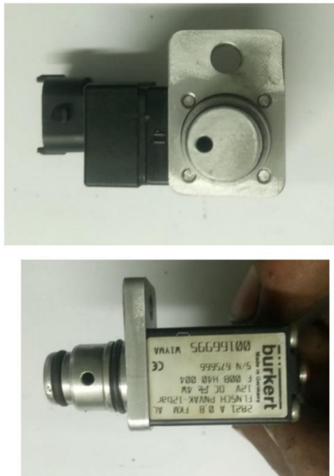
Figura 35: Eletroválvula de controle de fluxo de ar, sem obstrução
