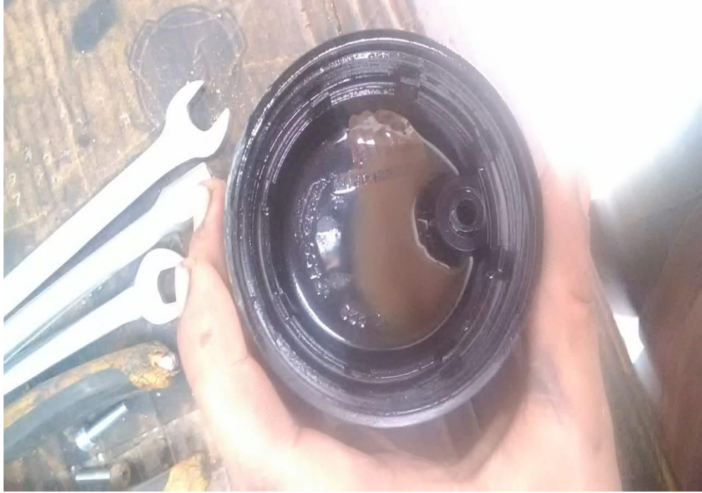
Figura 27: Tampa do filtro do Arla 32, contaminado.
