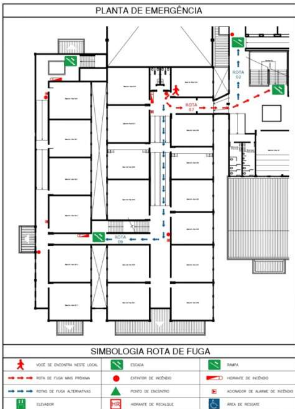
FIGURA 1: PADRÃO DOS MAPAS DE ROTA DE FUGA FIXADOS EM TODAS AS SALAS, CORREDORES, SANITÁRIOS, LABORATÓRIOS ETC
