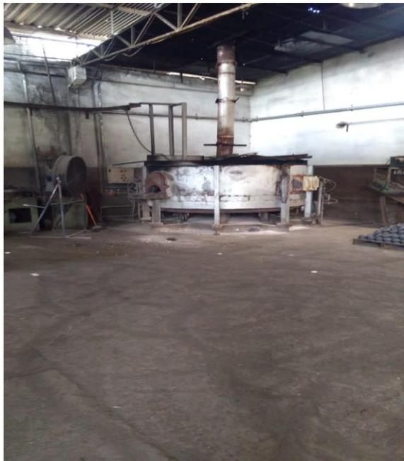
Ao fim do processo de forjamento e depois de inspecionadas, as peças são armazenadas no patio da forjaria 1 , e de la seguem para o setor de tratamento térmico, onde serão têmperadas em forno giratório a gás.
