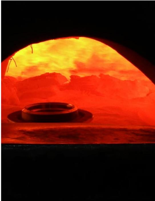
Figura 7 - Têmpera de flanges forno giratório.
