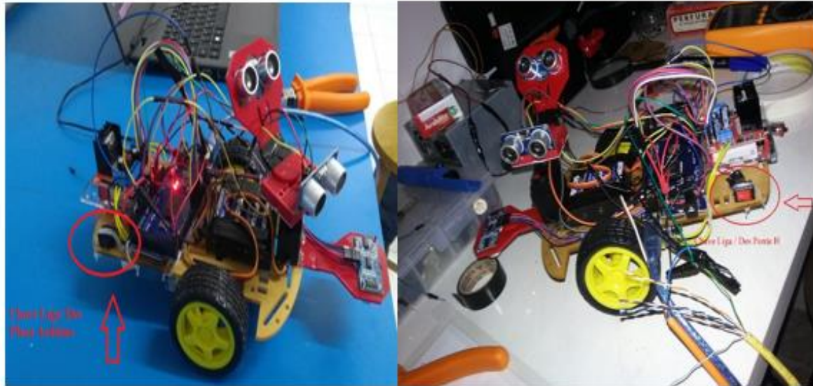
Figura 31 - (A) Indicação da chave de liga e desliga placa arduino, (B) Indicação da chave liga/desliga ponte H
