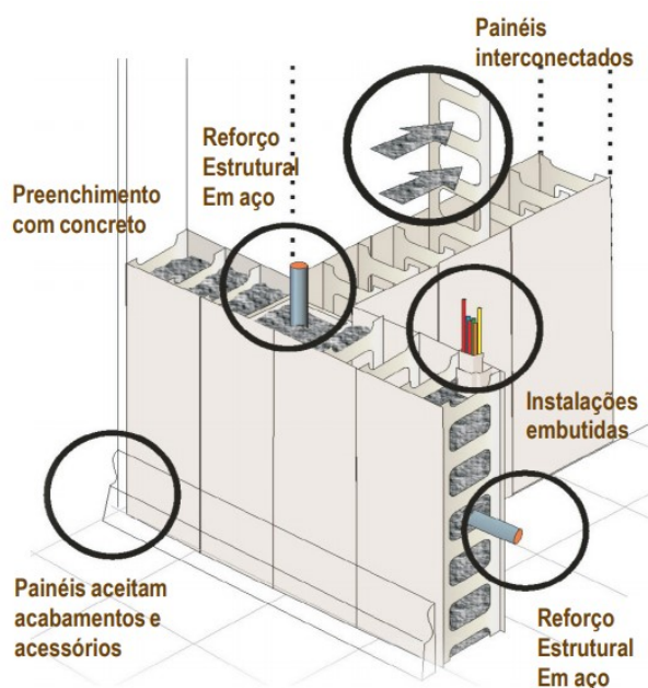
Figura 5 – Técnica painéis de PVC.
