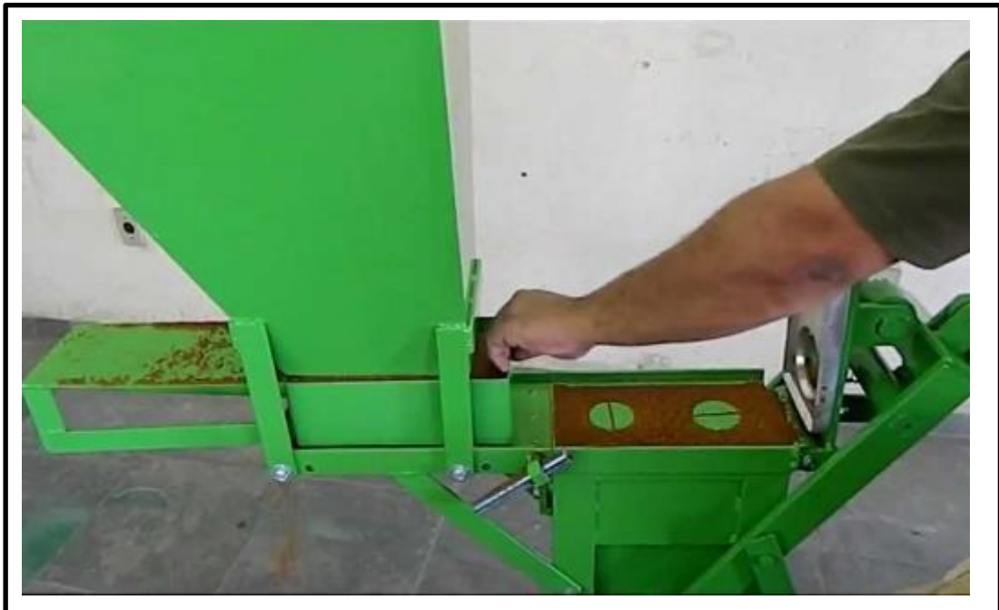
Figura 5: Prensagem da mistura (ECOMAQUINAS, 2017).
