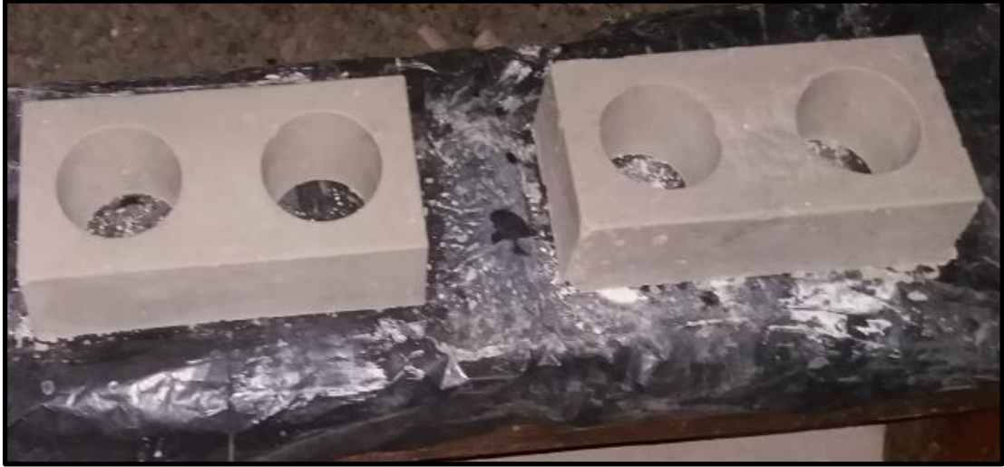
Figura 19: Tijolos em processo de cura
