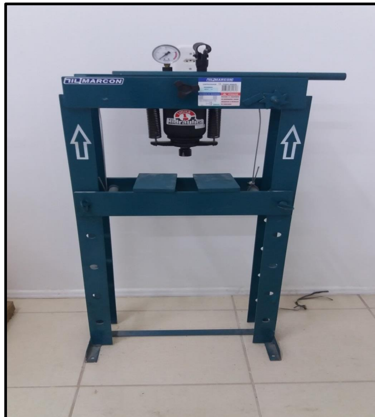
Figura 23: Prensa hidráulica manual , utilizada no teste de resistência
