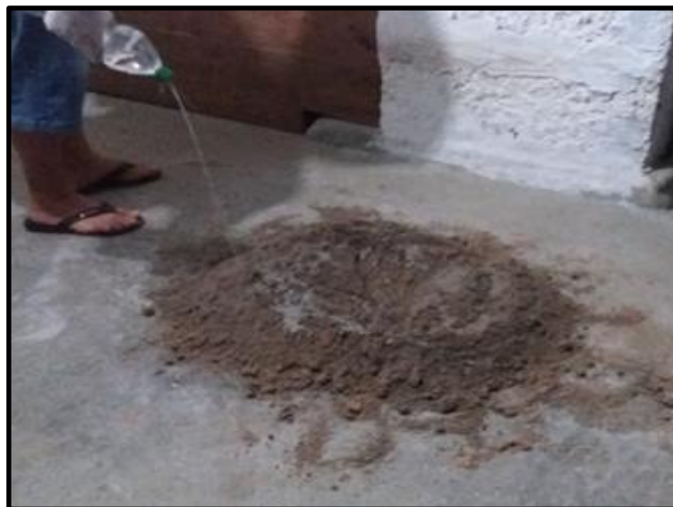
Figura 12 : Processo de adição da umidade
