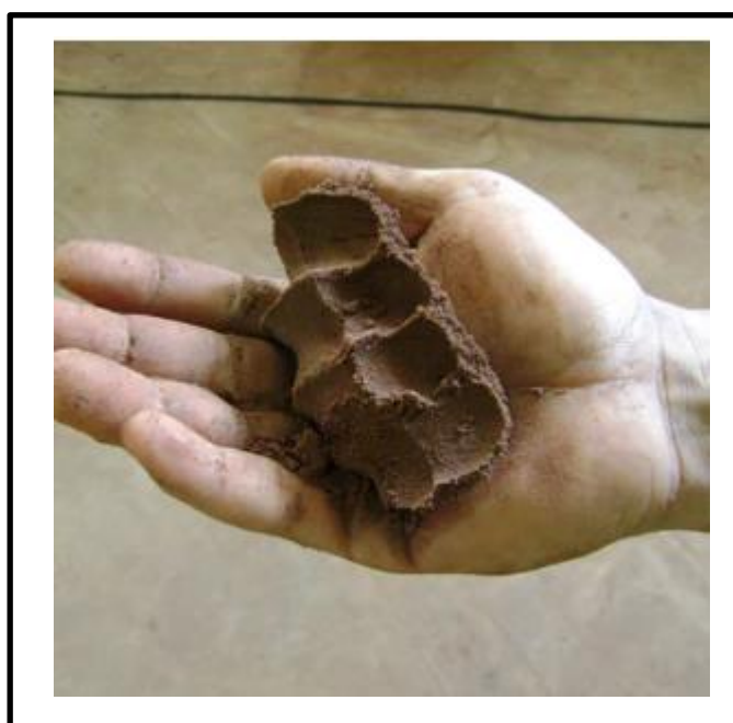
Figura 4: Teste de umidade (ECOMAQUINAS, 2017).
