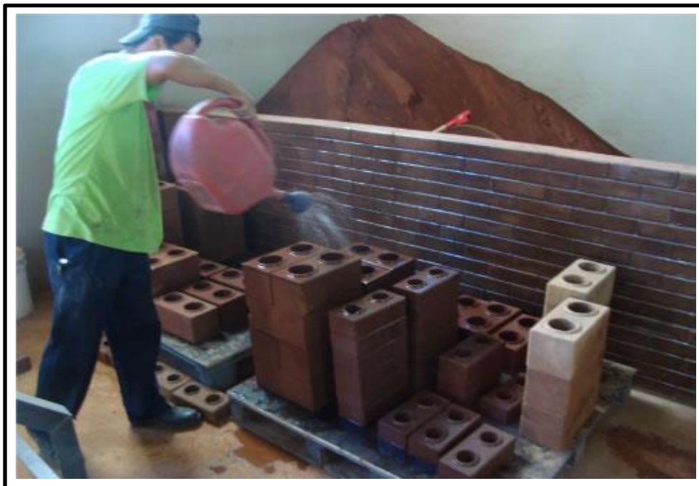
Figura 7: A cura dos Tijolos (ECOMAQUINAS, 2017).
