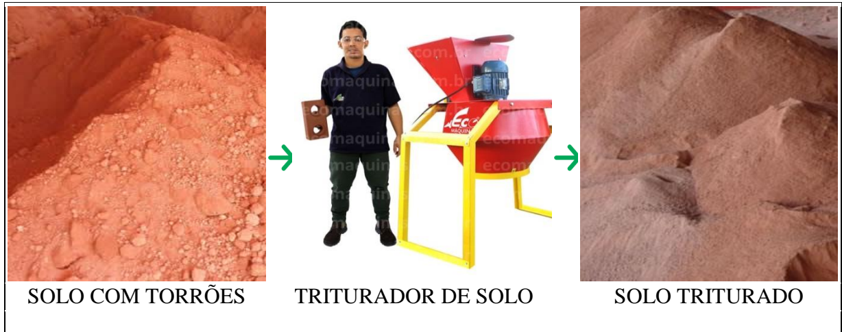
Figura 1: Processo de trituração do solo (ECOMAQUINAS, 2017).
