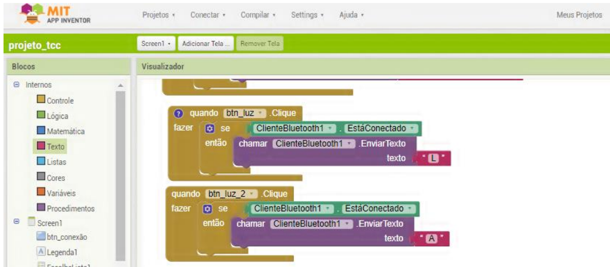
Figura 21 - Bloco de programação para acionamento dos LEDs
