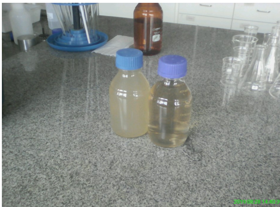
Figura 6– Amostra de esgoto bruto (esquerda) e esgoto tratado (direita), Laboratório 208- UFSC em Curitiba.
