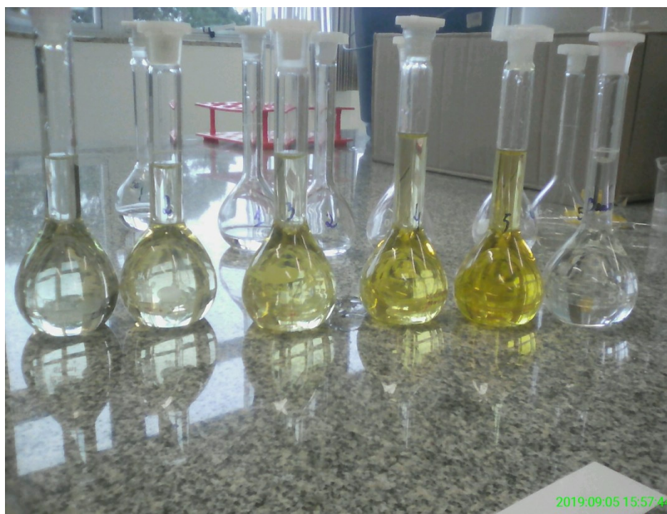
Figura 14– Padrões utilizados para obter a equação da reta que relaciona absorbância com concentração de fósforo.
