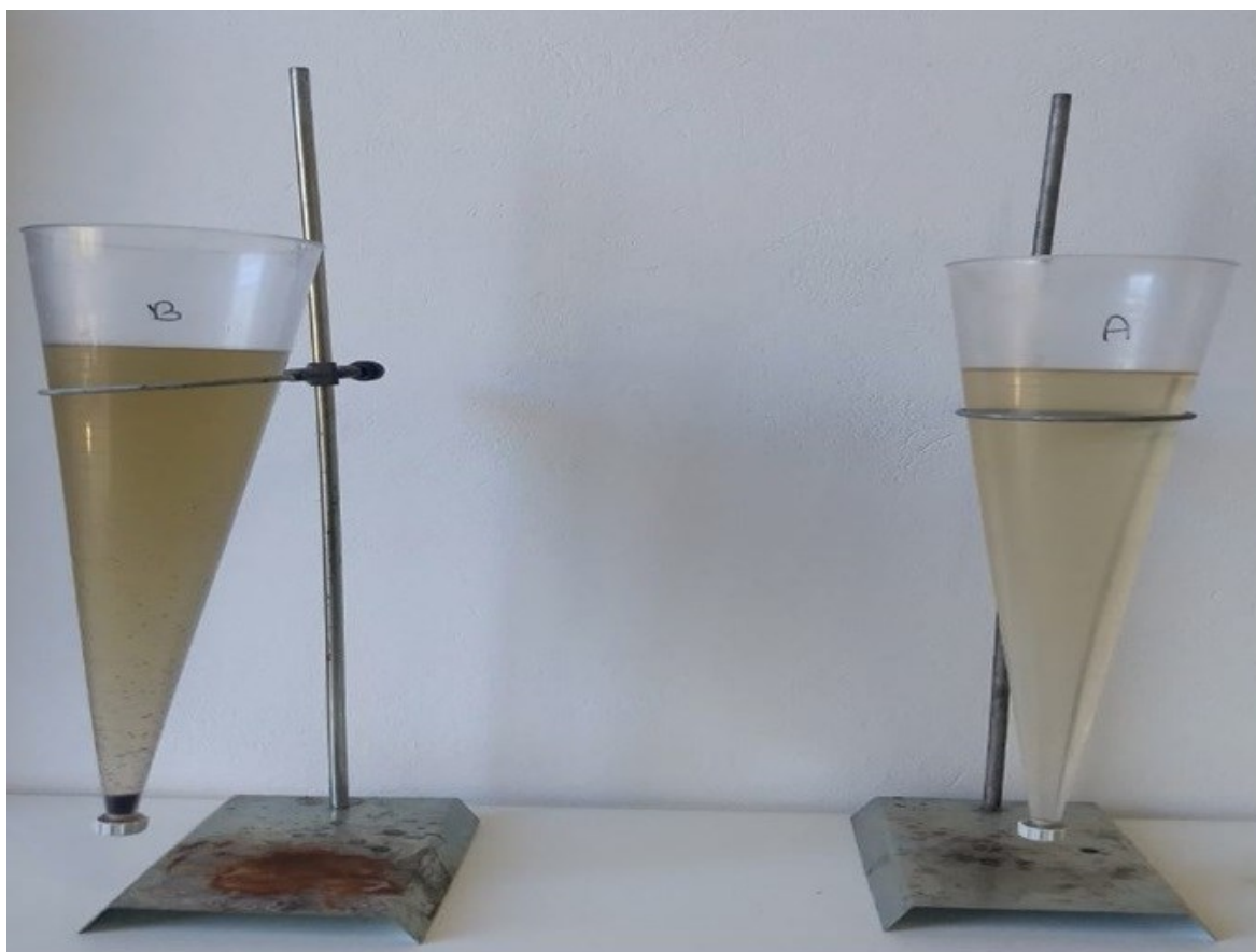
Figura 10– Análise de sólidos sedimentáveis em cone Imhoff, a direita esgoto tratado, a esquerda esgoto bruto.
