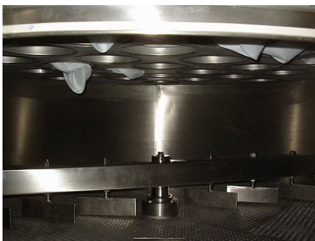
FIGURA 3: COMPARTIMENTO PARA MISTURA DO QUEIJO RALADO E ADITIVOS.
