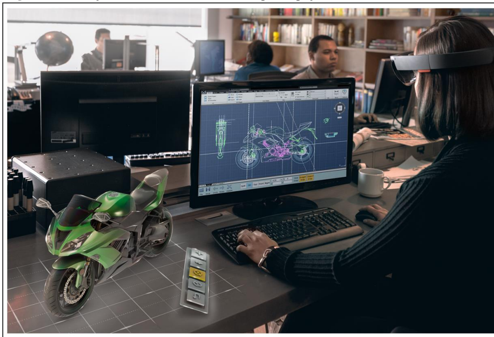
Figura 2. Utilização do HoloLens auxiliando na prototipação.
