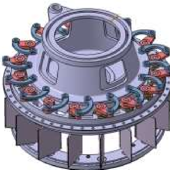
Figura 4 – Regulação de Velocidade para Turbinas Francis
