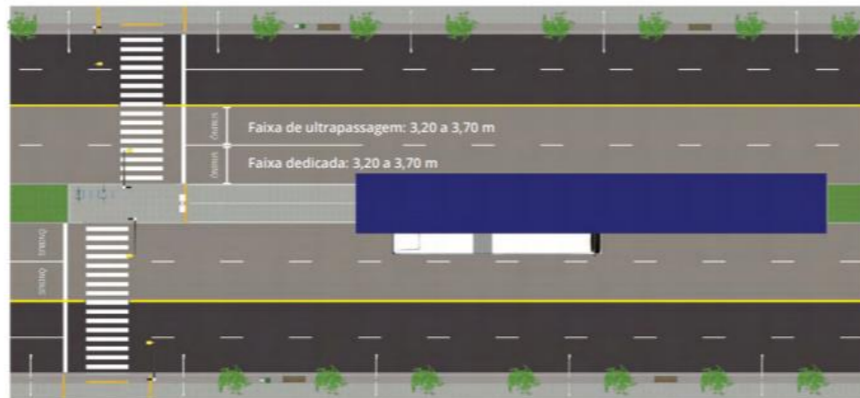
FIGURA 156 - DIMENSIONAMENTO DE FAIXAS. FONTE: CADERNO TÉCNICO DE MOBILIDADE URBANA.
