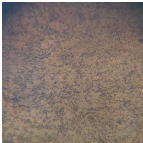
Figura 45: Micrografia material de adição pelo processo arame tubular
