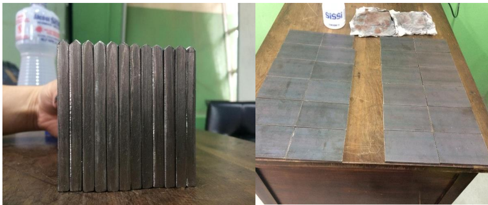
Figura 18: Chanframento e limpeza da pecas a serem soldadas
