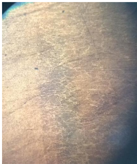
Figura 48:Material de adição X material de base, processo de soldagem arame tubular com gás de proteção CO 2
