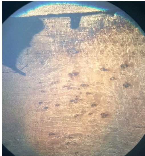
Figura 49: Poros processo de soldagem MIG, material de adição
