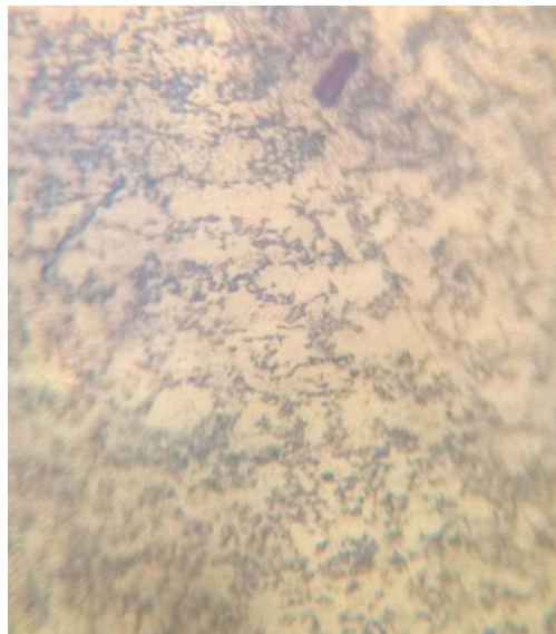
Figura 40: Material de base, processo com arame tubular
