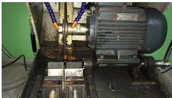
Figura 27: Policorte metalográfico com refrigeração
