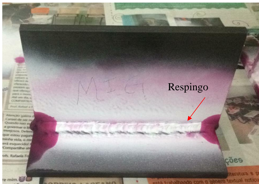
Figura 24: Análise líquido penetrante em solda MIG
