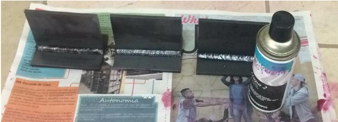
Figura 22: Aplicação do removedor
