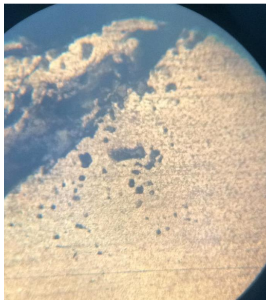
Figura 50: Segregações causadas pelo processo de soldagem MAG, material de base
