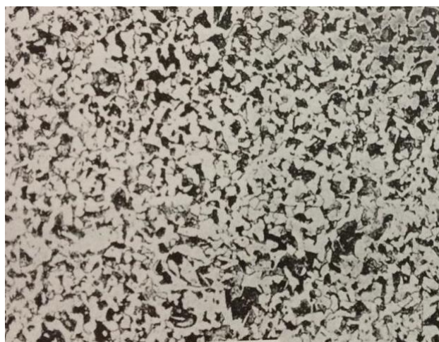
Figura 38: Aço com cerca 0,3% carbono resfriado lentamente. Ferrita e perlita
