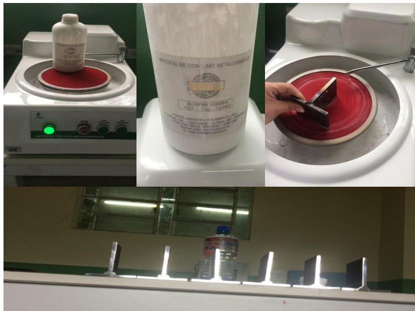
Figura 29: Polimento das superfícies a serem analisadas com alumina
