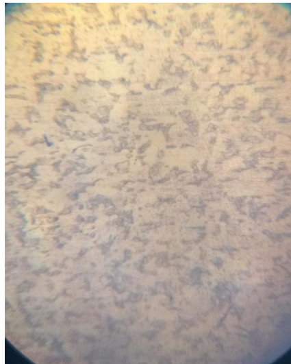
Figura 39: Micrografia material de base, junta soldada pelo processo MAG
