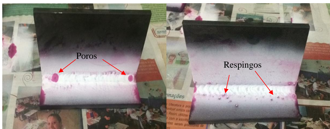
Figura 26: Análise líquido penetrante em solda com arame tubular com gás de proteção CO 2
