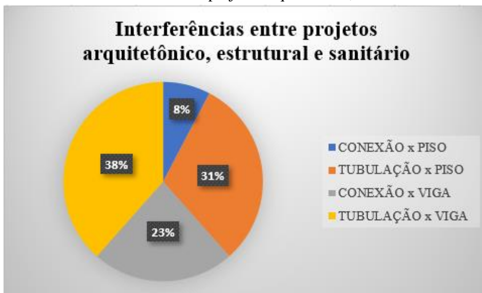
Gráfico 2: Interferências entre projetos arquitetônico, estrutural e sanitário
