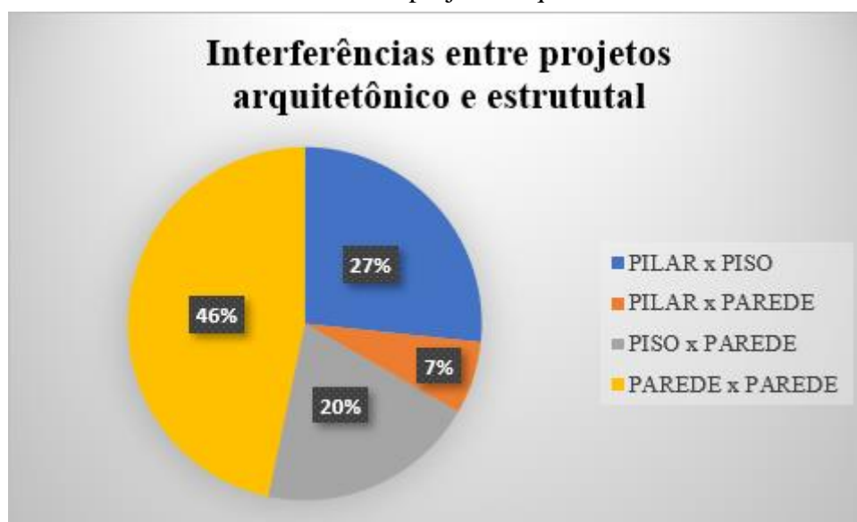
Gráfico 1: Interferências entre projetos arquitetônico e estrutural
