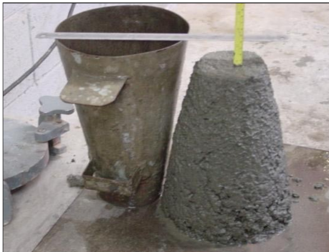
Figura 5 – Medição de abatimento
