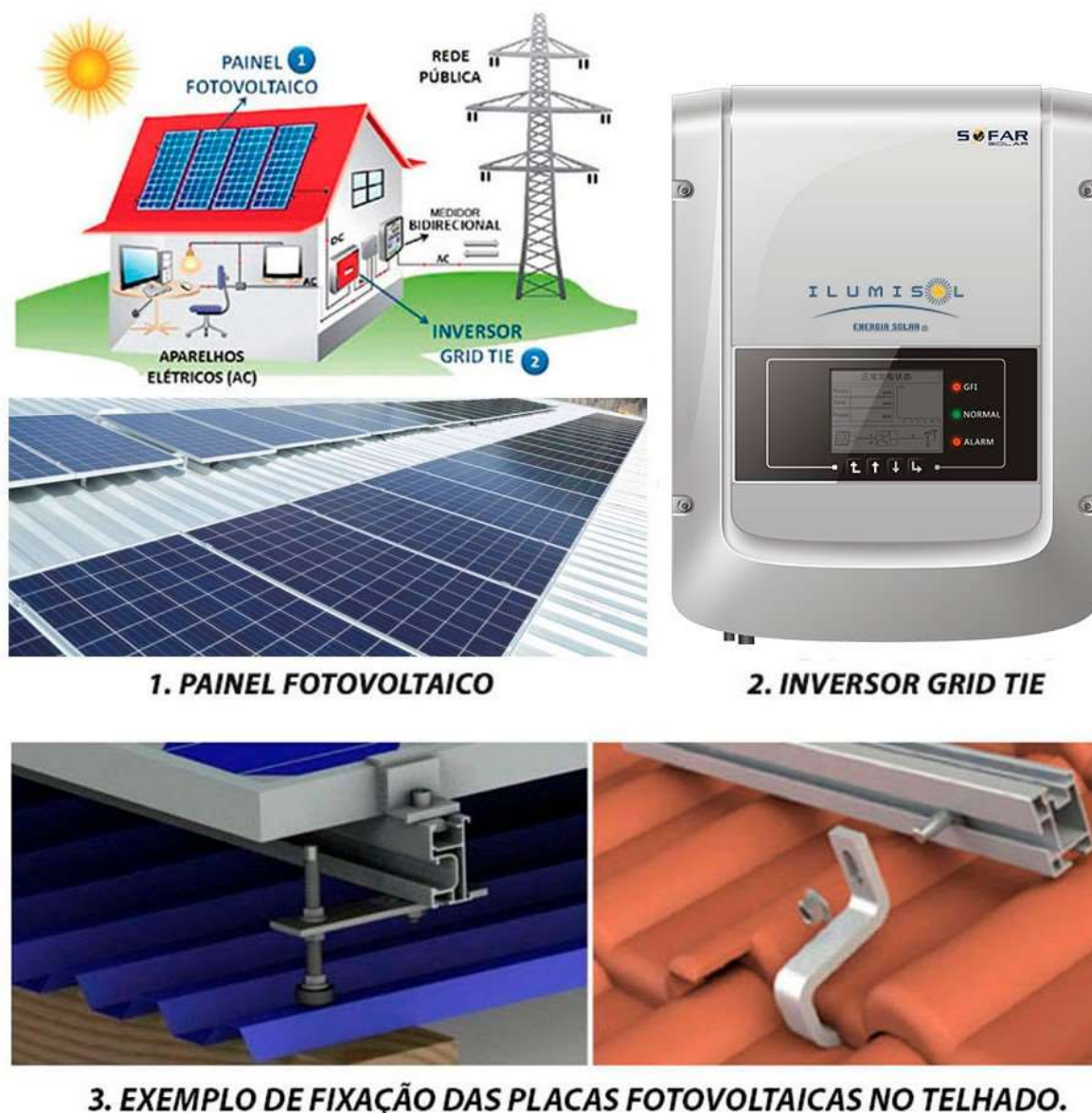
Figura 18 - Materiais necessários para instalação da GD.
