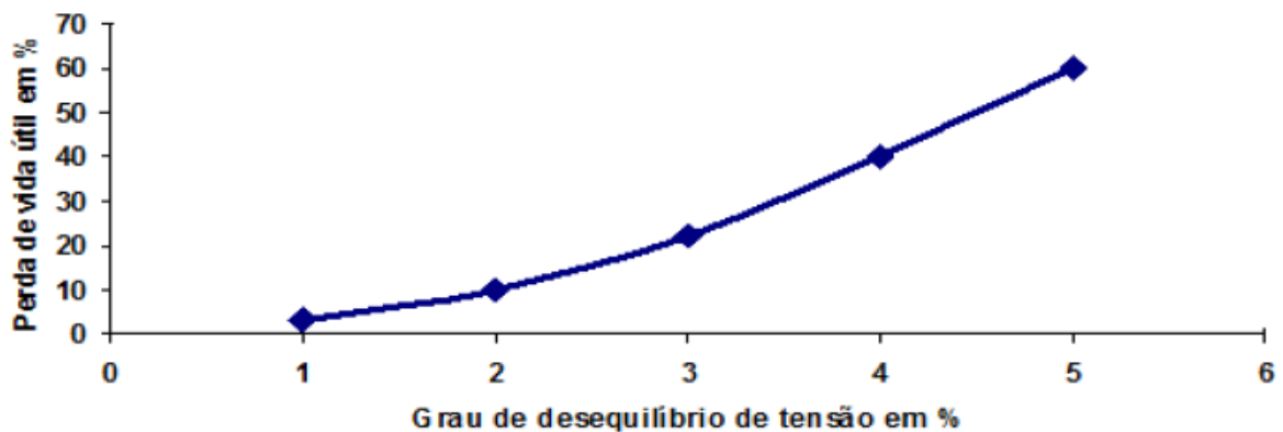
Figura 16 - Relação entre a vida útil e o desequilíbrio de tensão
