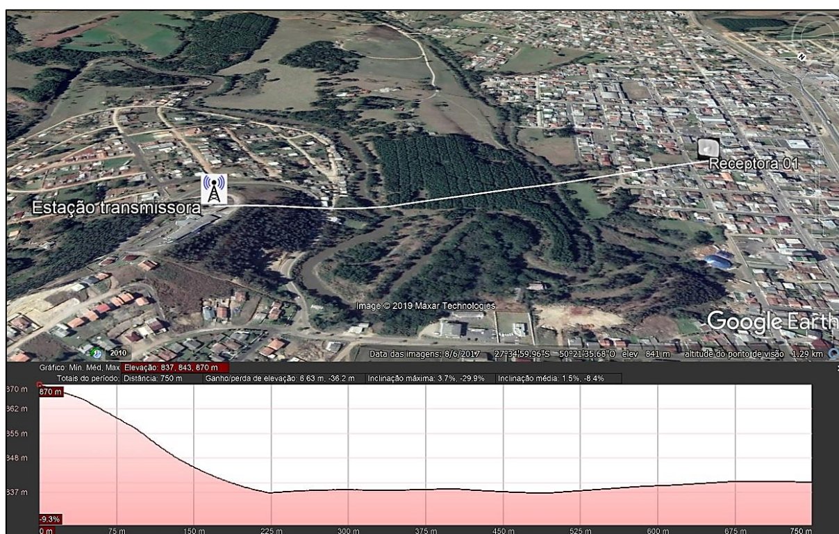
Figura 71 – Perfil de elevação entre a antena receptora 01 e a torre de transmissão.
