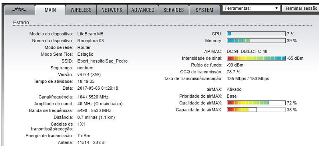
Figura 81 – Informações da conectividade entre Receptora03 e Ebert_hospitalSao_Pedro.
