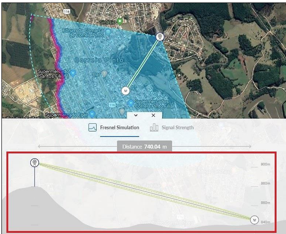
Figura 72 – Zona de Fresnel entre a antena receptora 01 e a torre de transmissão.
