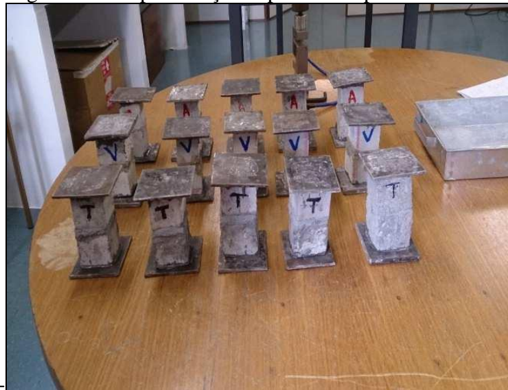
Figura 5 – Chapas de aço acopladas aos prismas de teste
