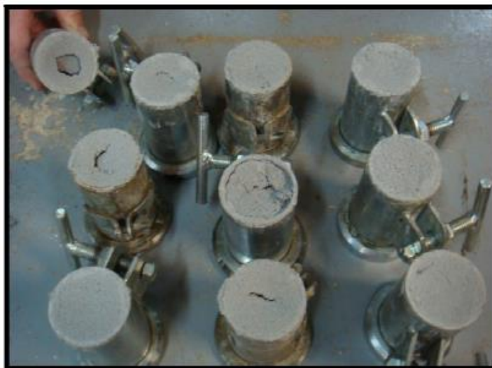
Figura 3 - Retração dos corpos de prova da argamassa não cimentícia
