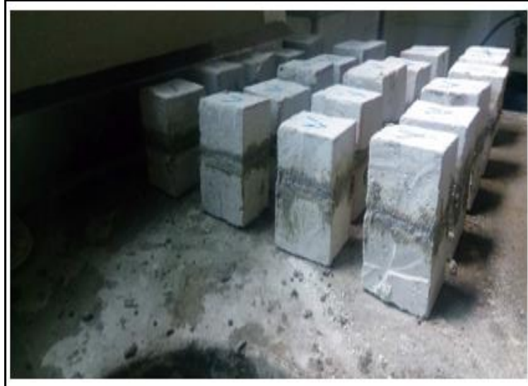
Figura 4 - Prismas de teste
