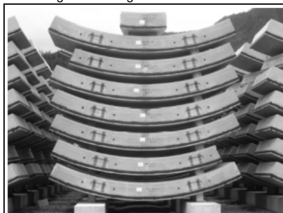
Figura 11 - Segmentos de concreto
