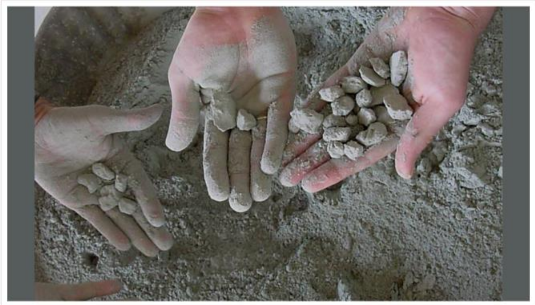
Figura 2 – Cimento empedrado devido à má estocagem.
