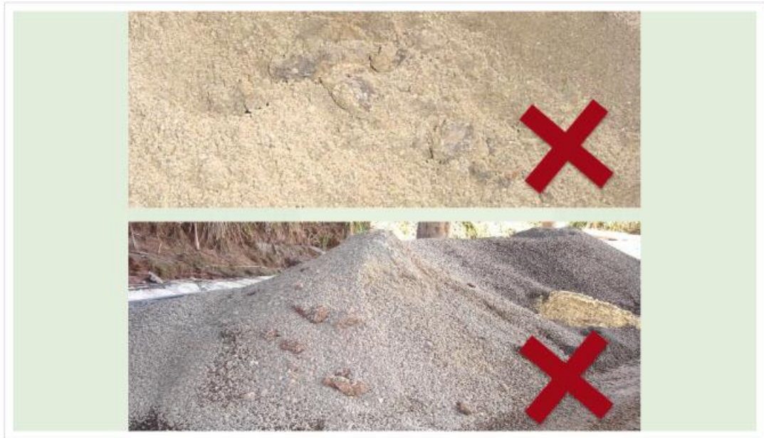
Figura 8: Exemplos de agregados contaminados.
