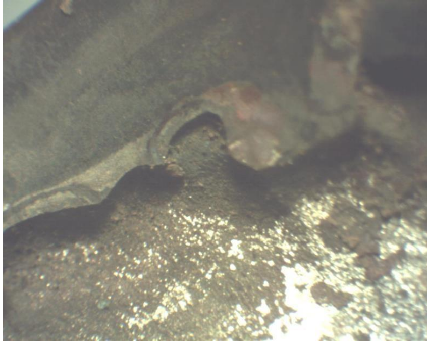
Figura 13 Imagem de microscopia ótica próxima do início do tubo com defeito. 30x aumento.
