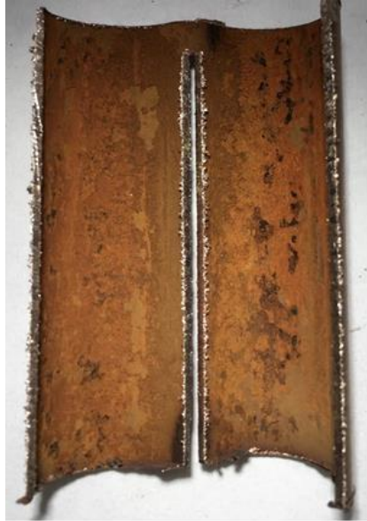
Figura 12 Seção longitudinal do tubo com defeito a 100 mm da entrada.
