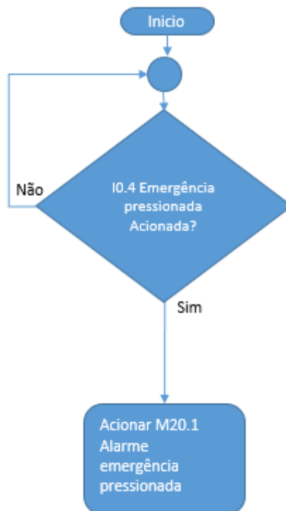
Figura 98 - Fluxograma - Alarme Emergência Pressionada
