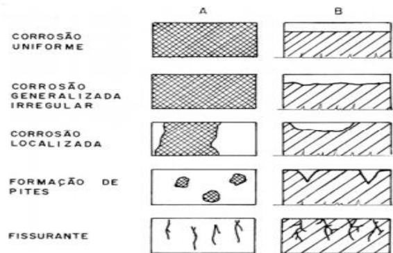
Figura 20 – Tipologia da corrosão do aço. (A) vista superior, (B) vista lateral
